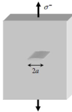
**Figure I.4 :** Fissure traversante de longueur  $2a$  dans une plaque infinie
