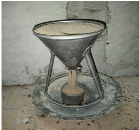
Figure II.07. Essai de La masse volumique apparente.
