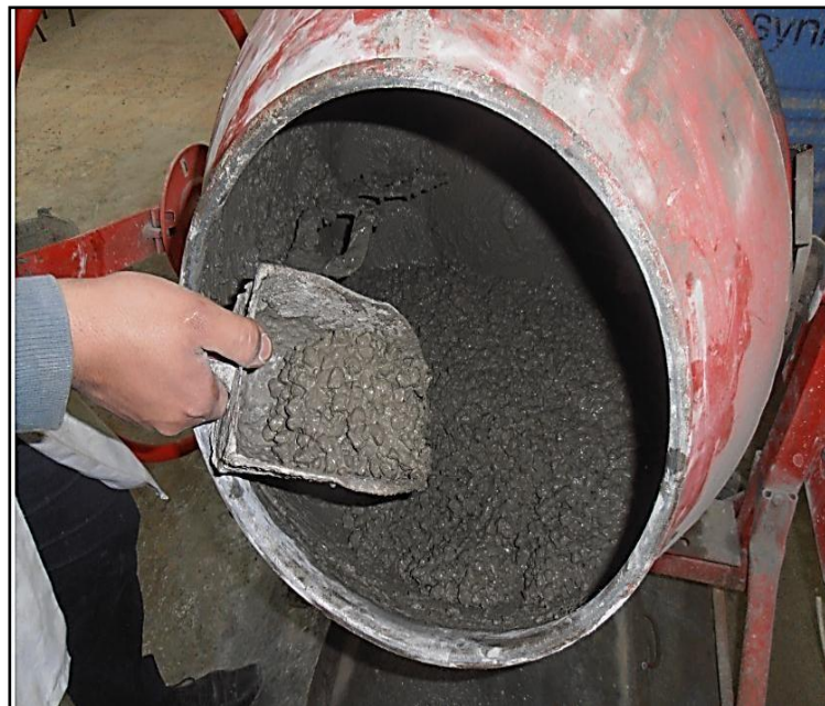
Figure II.24. Bétonnière utilisée pour le malaxage des composants.
