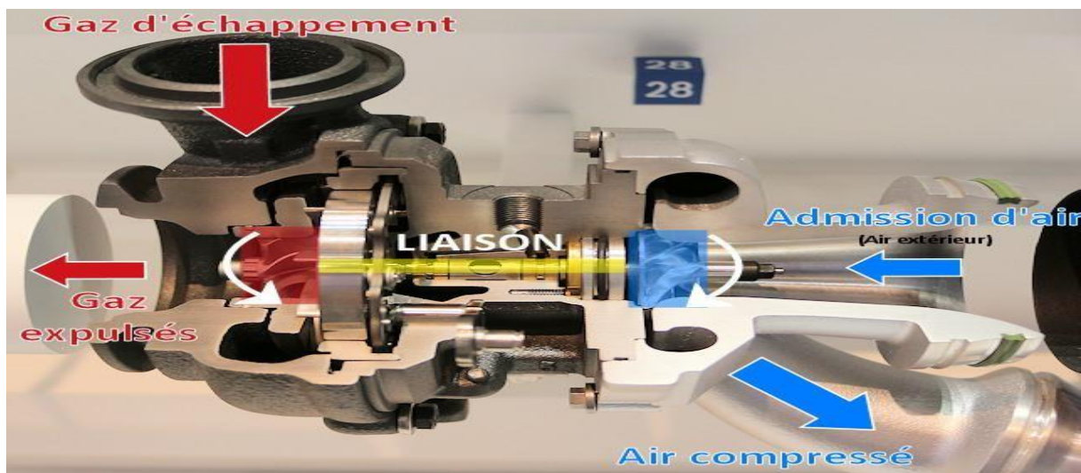
Figure I.9 : un schéma montrant le Principe de fonctionnement d'un turbo [12].
