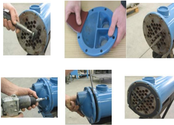
Figure III.9 : comment nettoyer un refroidisseur d'huile [21].
