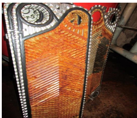
Figure I.26: Entartrage d'un échangeur qui utilise l'eau de mer [7]
