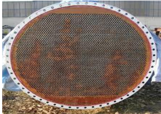
Figure I.25 : La corrosion dans un échangeur industriel [7]
