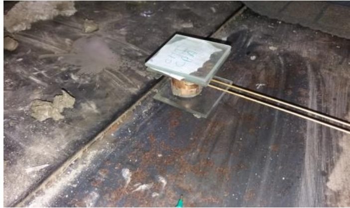
Figure II.13: Moule à aiguille Le Chatelier.
