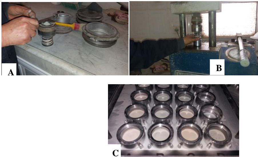
Figures II.19 : Les étapes de la spectrométrie par fluorescence.
