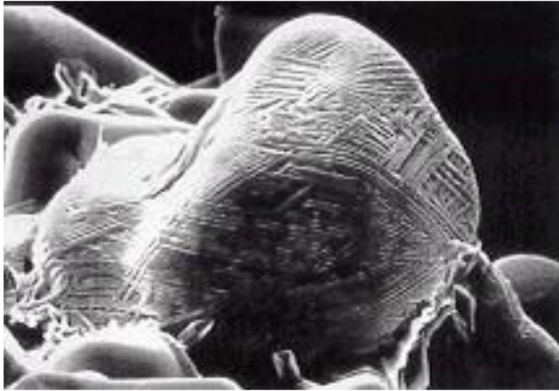
Figure I.4 : Micrographie MEB des cristaux de la Bélite[Altun I. A, 1999].
