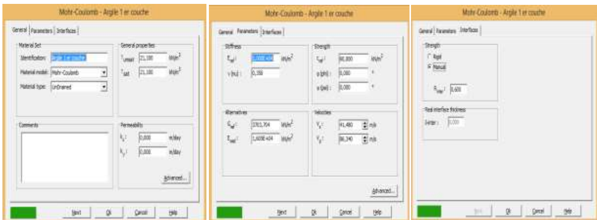
Figure 4.48 : Fenêtre des caractéristiques générales relatives des colonnes ballastées
