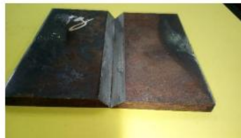
Figure (IV.1) : Tôles après soudage
