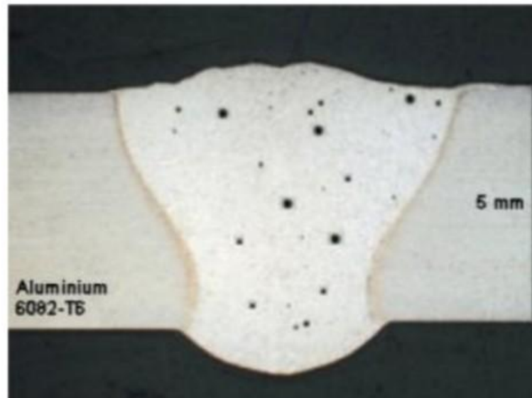
Figure (II.6) : Les différents types de soufflure.[45]
