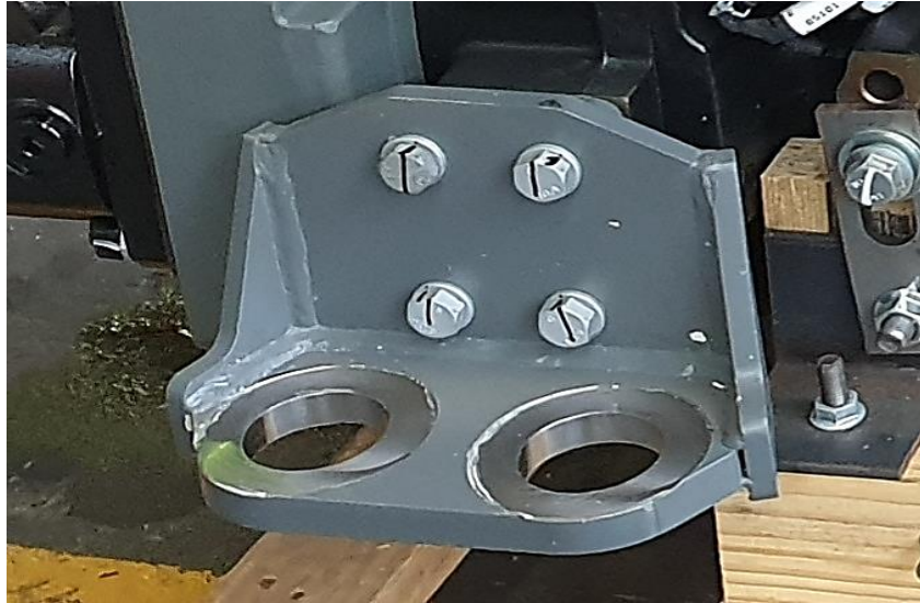
Fig-IV.8 Console moteur avant
