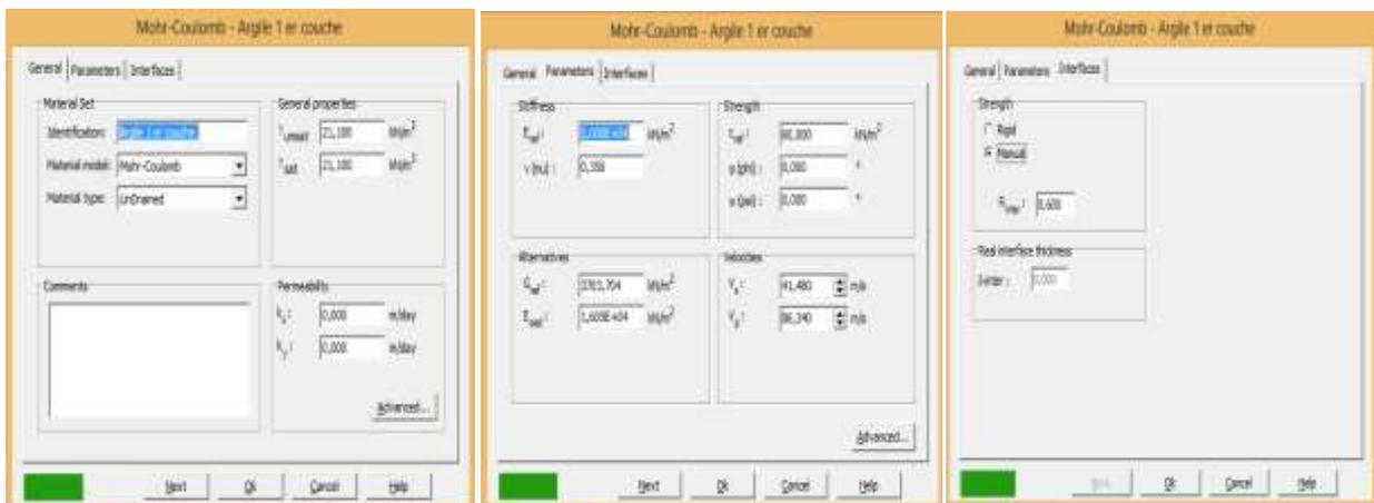
Figure 4.49 : Fenêtre des caractéristiques générales relatives aux couches d'Argiles SC03 –05–06
