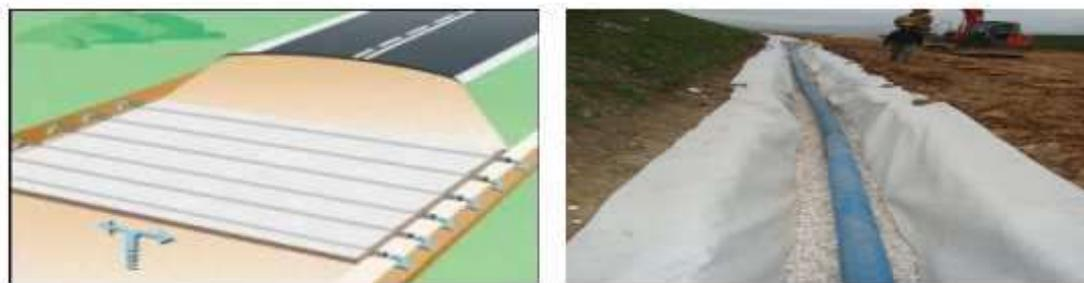
Figure 1.8. Utilisation des géotextiles pour le drainage.
