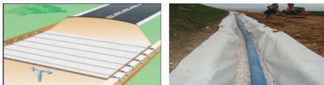
Figure 1.8. Utilisation des géotextiles pour le drainage.
