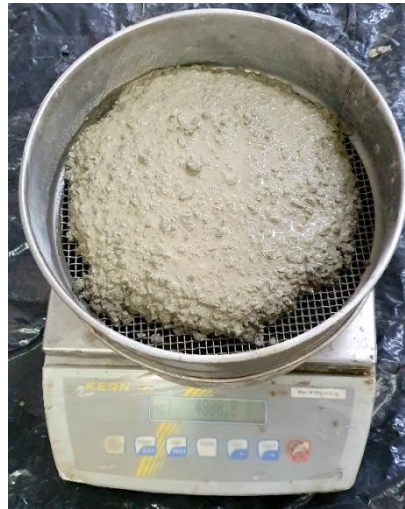
Figure II.9. Essai de stabilité au tamis
