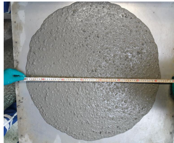
Figure II.6. Mesure de diamètre à l'essai au cône d'Abrams.
