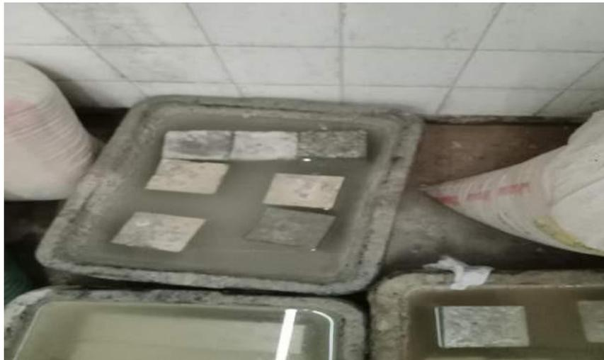
**Figure II.12** : conservation des éprouvettes.
