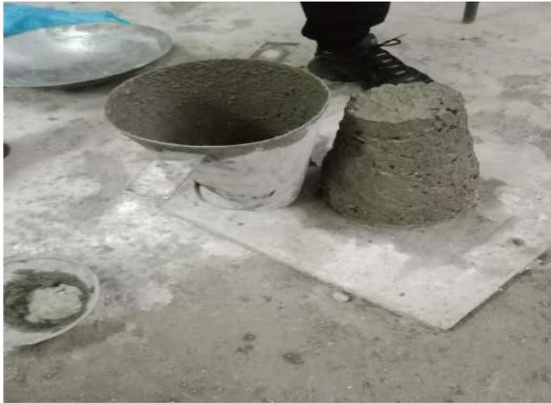
**Figure II.10** :Essai d'affaissement au cône d'Abrams.
