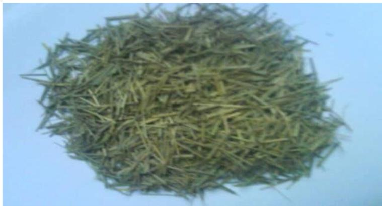
**Figure II.7 :** Fibre de diss après concassage et découpage.
