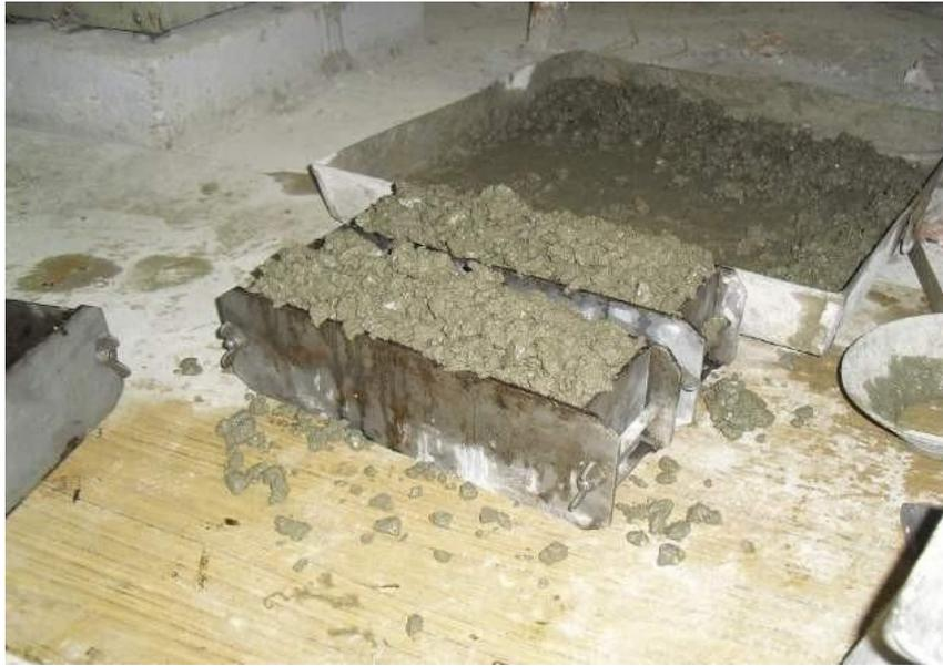
**Figure II.11** : moulage du béton avant vibration.
