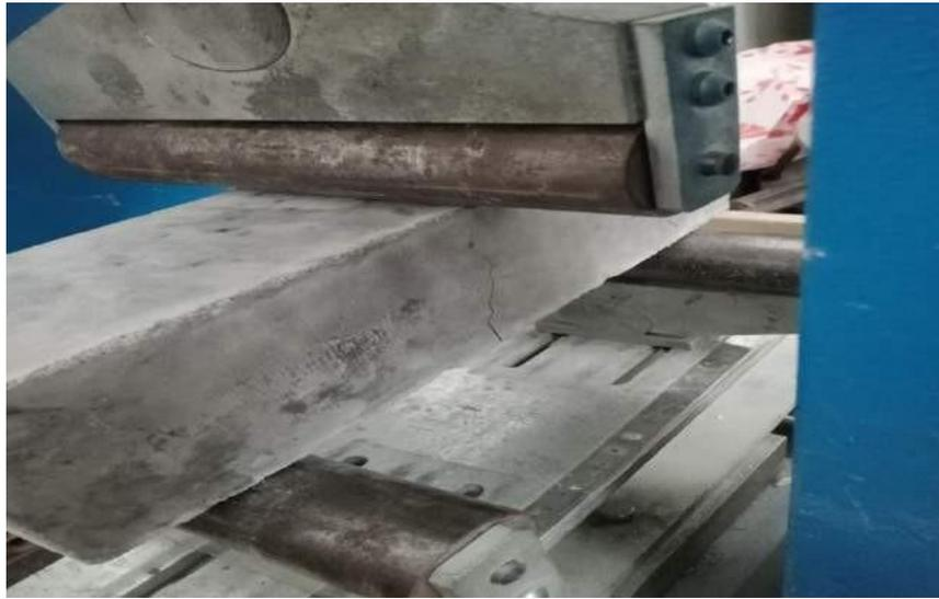
**Figure II.14 :**Essai de traction par flexion.
