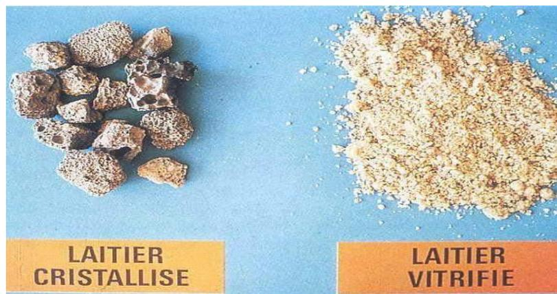
**Figure I.2 :** laitier cristallisé et granulé. [3]
