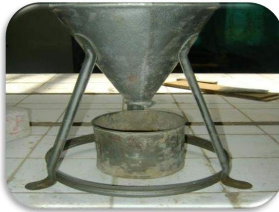
**Figure II .1 :** Essai de la masse volumique apparente.
