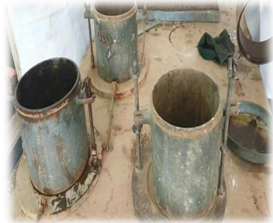
Figure 2.25 Les Moules CBR.
