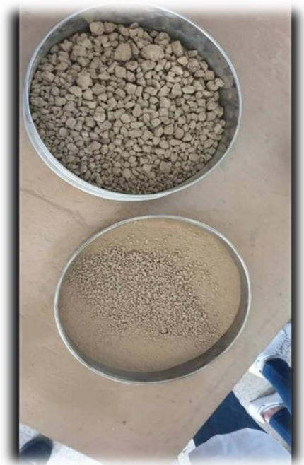
Figure 2.20 Matériau tamisé en 5mm
