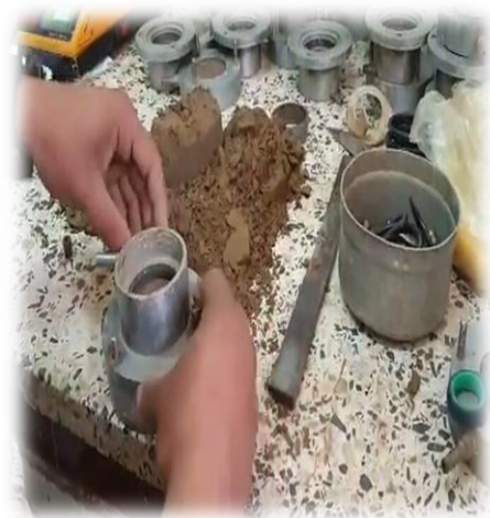
Figure 2.40 préparation De l'échantillon.
