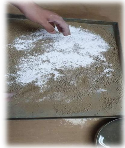
Figure 2.42 Mélange du sol sec avec la chaux
