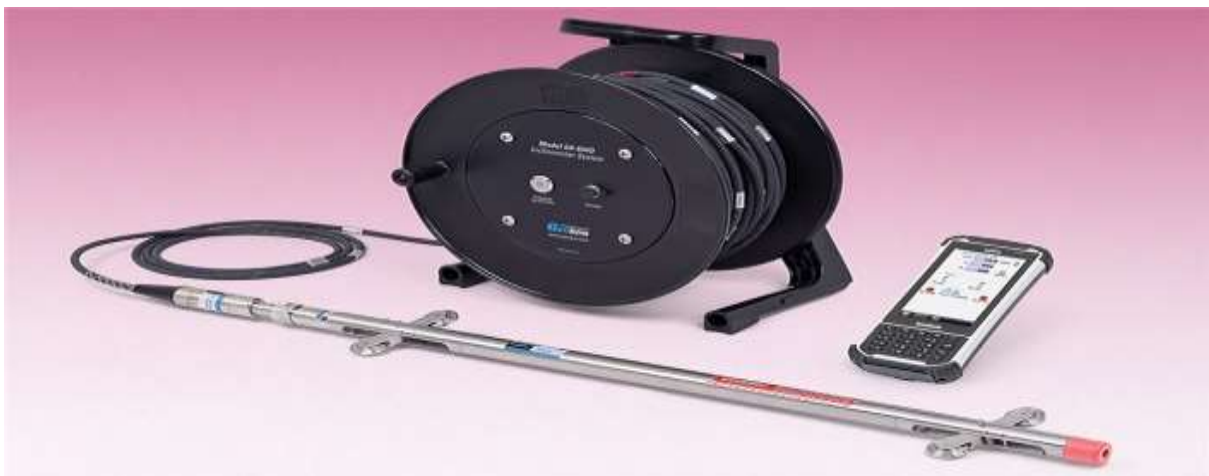
Figure 46 :L'appareillage de l'inclinomètre
