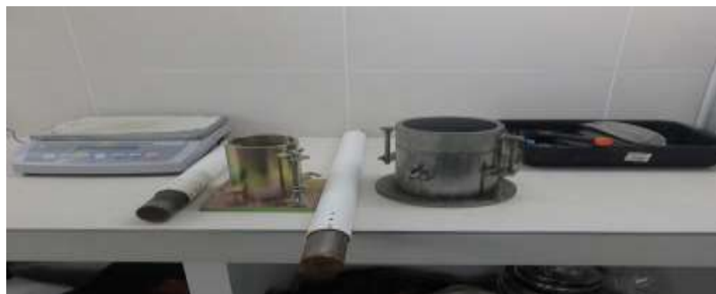
Figure 53 : matérielle de l'essai Proctor
