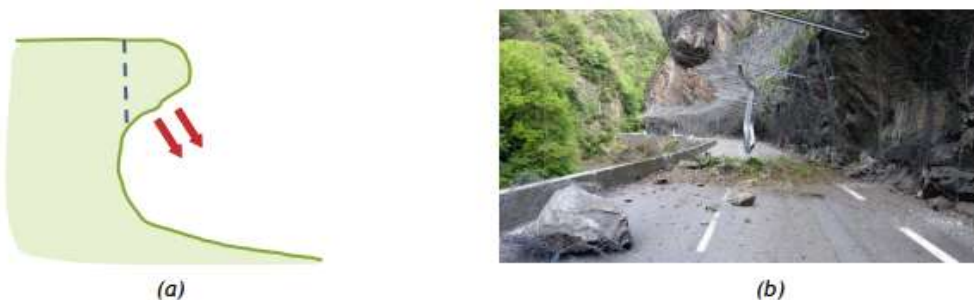
Figure 4 : Schématisation du phénomène d'éboulement, (b) mai 2017, éboulement sur la RD921 dans les Hautes Pyrénées, photo Laurent Dard et M.V.-B.[3]
