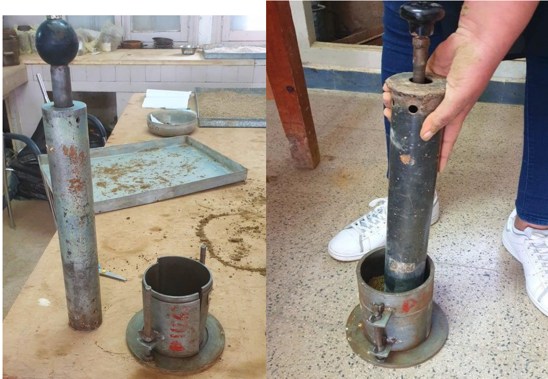
Figure II.12 : Appareillage nécessaire pour l'essai Proctor.
