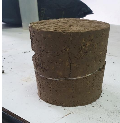
Figure III.4: Proctor avec une nappe de géotextile
