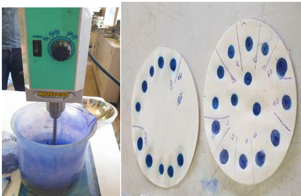
Figure II.26 : Essai au bleu de méthylène.
