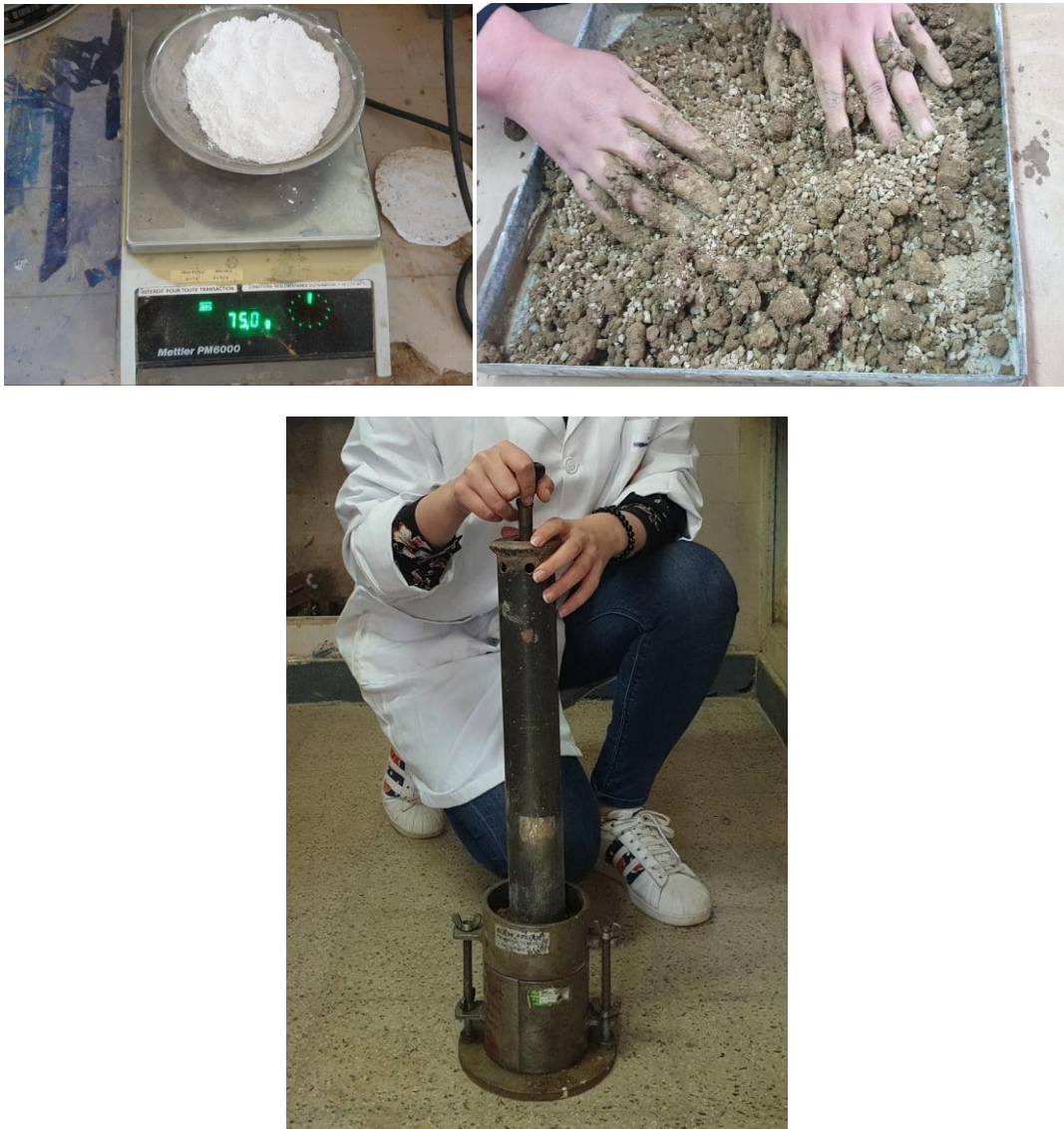
Figure II.29 : Les étapes de l'essai Proctor
