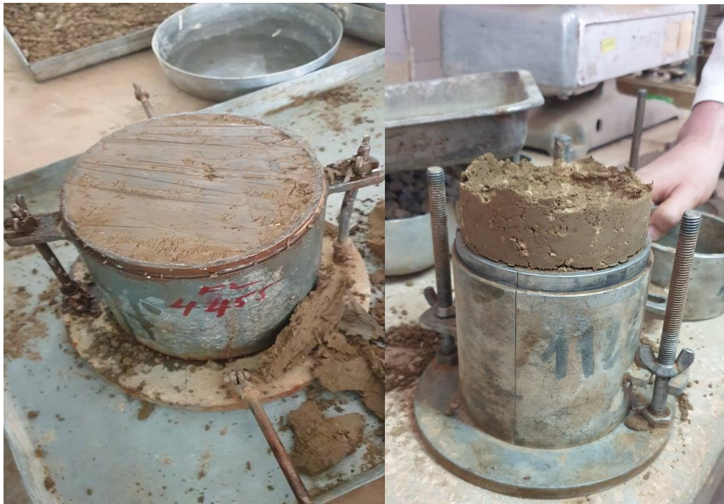
Figure II.32 : préparation du moule de CBR
