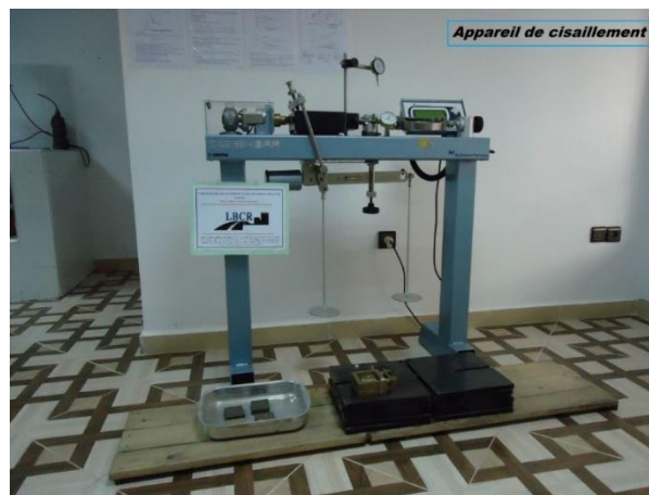
Figure II.21 : préparation et appareil de Cisaillement Direct.
