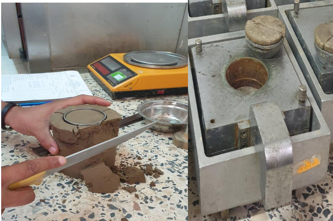
Figure II.37 : Détermination du cisaillement
