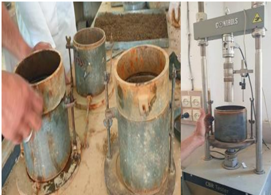
Figure.II.14 : Mode opératoire de CBR
