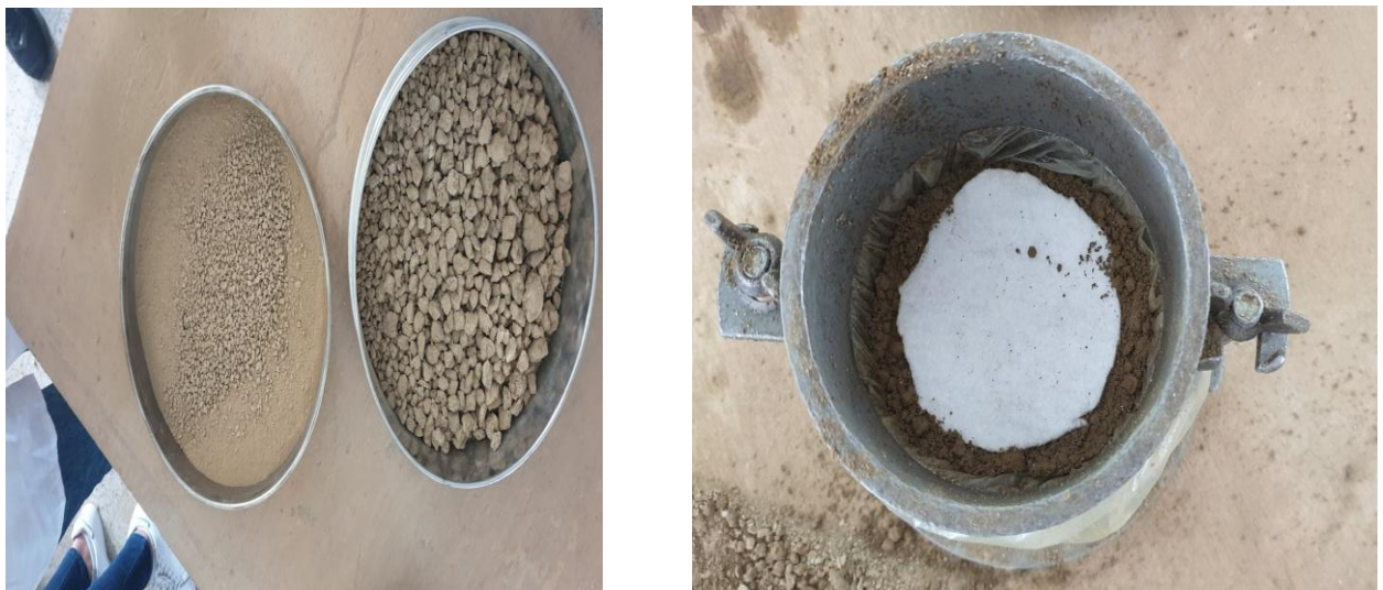
Figure III.3 : Préparation au Proctor
