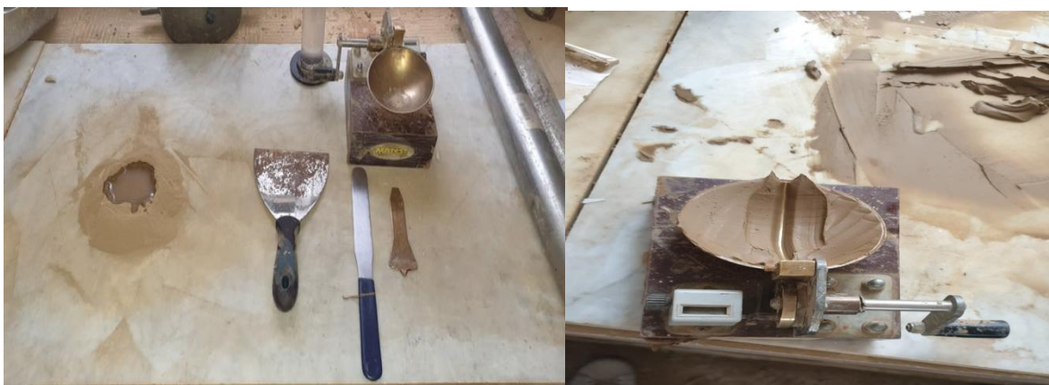
Figure II.8 : Matériel utilisé dans l'essai de Limites d'Atterberg
