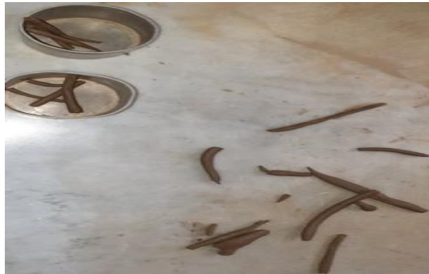
Figure II.10 : Détermination la Limite de Plasticité.
