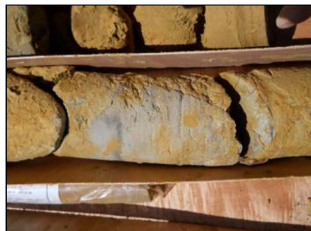
Carotte de la couche de sable argileux mêlé de graviers au trou B5 (à 17.4m)
