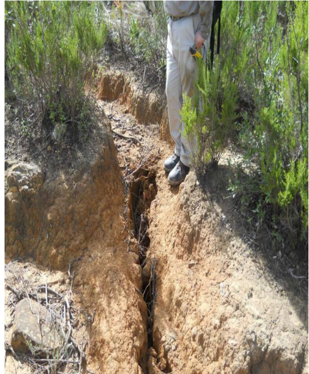
Photos 3.3 État d'apparition des fissures de traction
