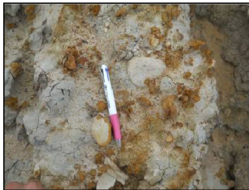
Affleurement de la couche de sable argileux mêlé de graviers (présence des graviers arrondis de grès dur)
