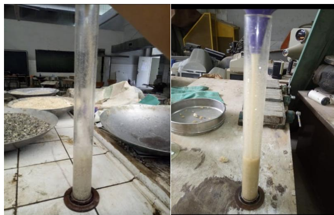
Figure II. 2 : Mesure de la masse volumique absolue du laitier granulé et sable siliceux.
