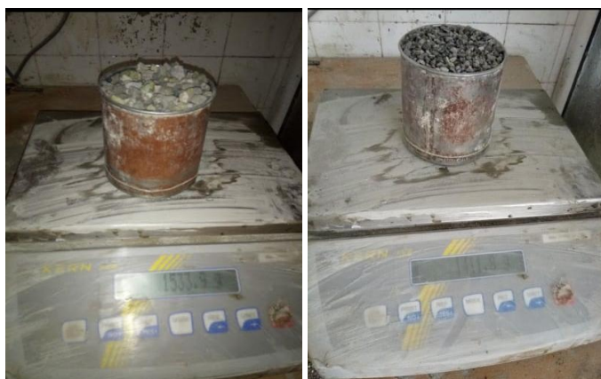
Figure II.4: Procédé utilisé pour déterminer de la masse apparente du laitier cristallisé (3/8 et 5/16)
