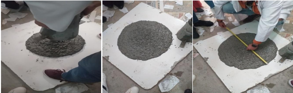
Figure III.6 : Etalement d'un BAP homogène , bonne répartition granulaire
