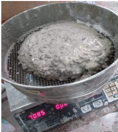
Figure III.9 : Essai de stabilité au tamis pendant les deux minutes d'attente
