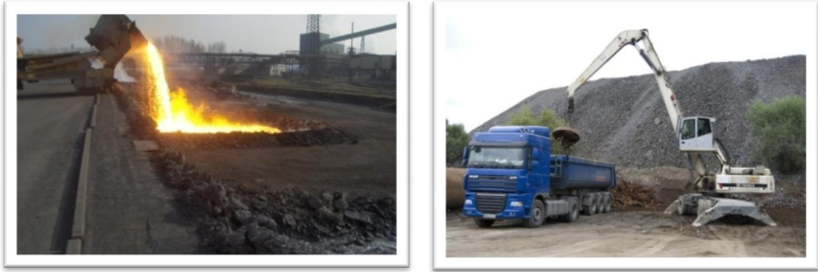
Figure I.3: Refroidissement lent du laitier cristallisé.
