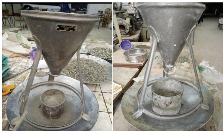
Figure II. 1 : Mesure de la masse volumique apparente du laitier granulé.
