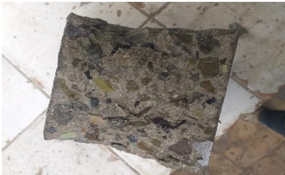
FigureIV.10 : Observation de la répartition granulaire du BAP
