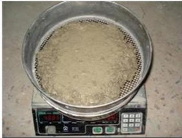
**Figure II.5.** Essai de stabilité au tamis
