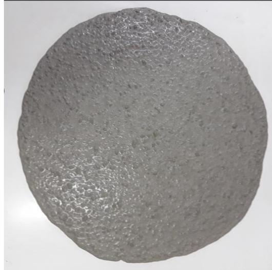
**Figure II.3.** Essai d'étalement
