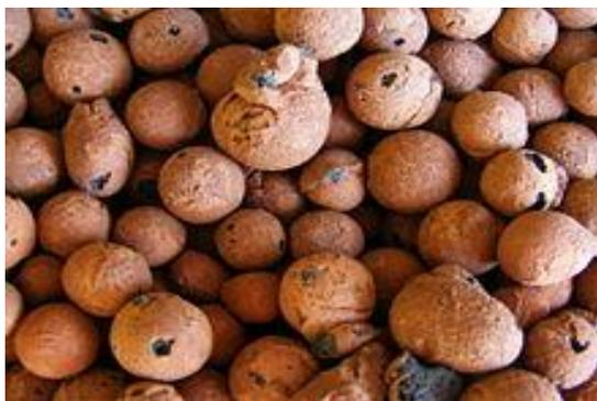
**Figure I.6.** Granulats argile expansée
