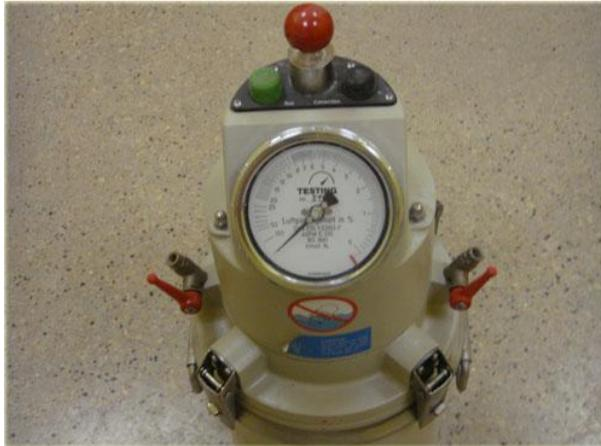
**Figure II.6.** Mesure de la teneur en air occlus du béton par la méthode du manomètre
