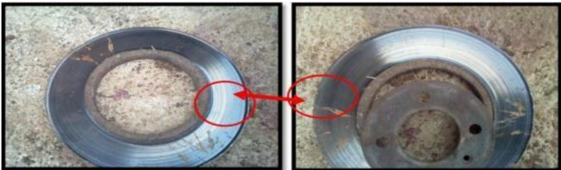
Figure III.14: Disque endommagé par le fer d'une plaquette. [17]
