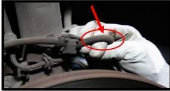
Figure III.4 : les craquelures du caoutchouc [14]
