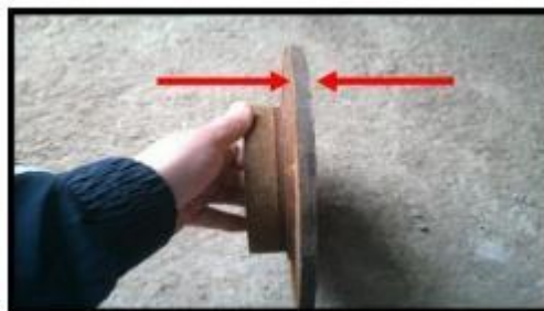
Figure III.13: Disque à l'usure très visible [17]
