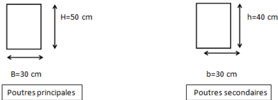
Figure II.1. dimensionnement des poutres
