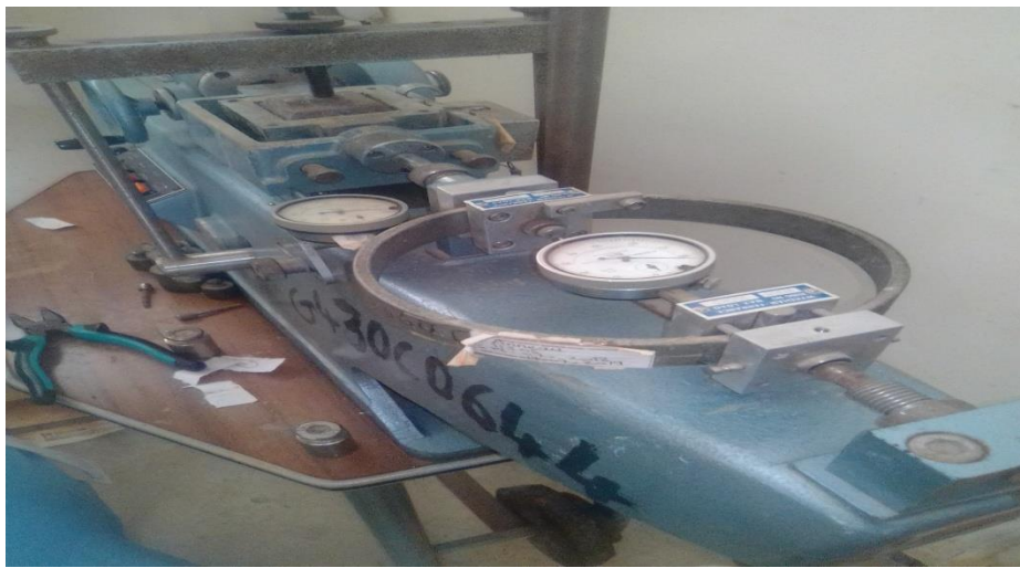
Figure 3.8 : Appareillage de l'essai de cisaillement
