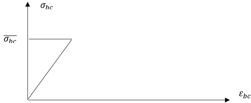
Figure I.2 : Diagramme Contrainte- déformation du béton à L'ELS
