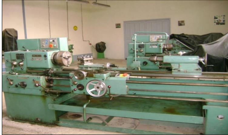
*Figure II.8 : Machine d'outil, Tour type TOS TRENCIN-SN40.*
