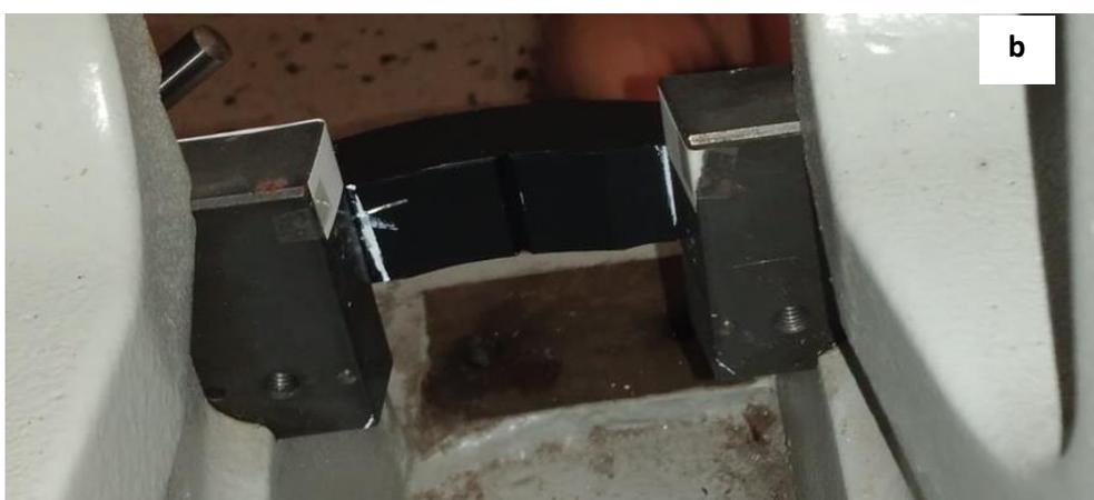
**Figure IV.5 :** Vues de l'éprouvette d'essai montée sur les appuis de la machine ;
