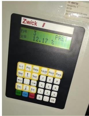
*Figure IV.6 : Afficheur numérique de la machine avec (n) le numéro de l'essai et (x) l'énergie mesurée en %.*
