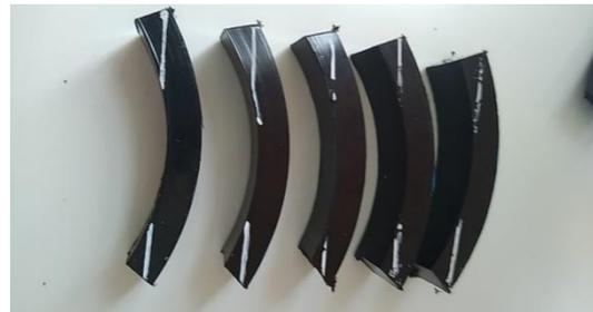
*Figure II.9 : découpage des éprouvettes avec une fraise scie.*
