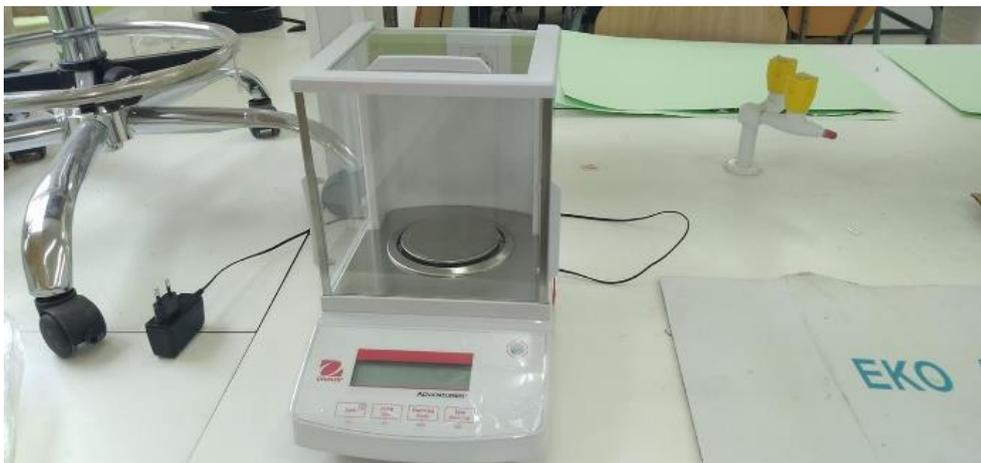
*Figure III.4 : Balance OUHAUS instrument.*
