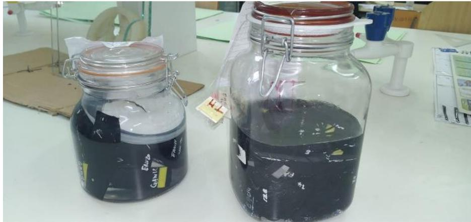
*Figure III.3 : Bocal en verre pour l'immersion des éprouvettes.*
