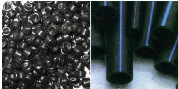
**Figure I.2** : Matière première PE sous forme de granulés et tube HDPE [9].
