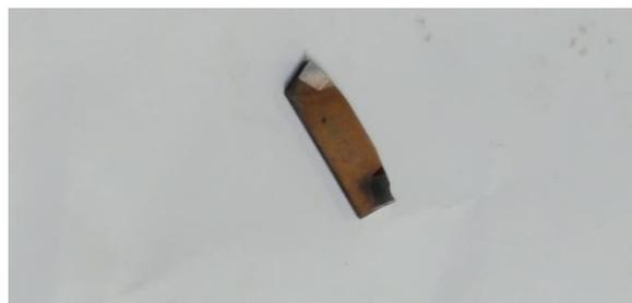
**Figure II.4 :** Outil de tournage utilisé pour découper les anneaux.
