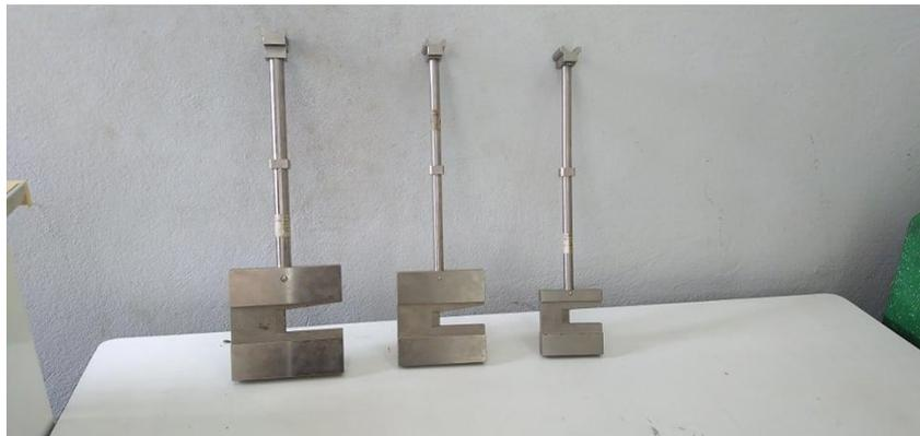
*Figure II.14 : Le différent mouton pendule 7,5 J, 15J, 25J.*
