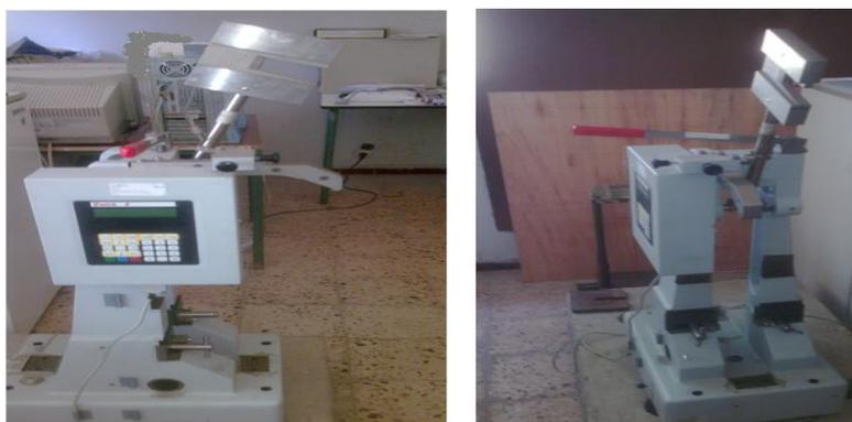
**Figure II.13** : Dispositif de l'essai de choc ZWIKI 5113.
