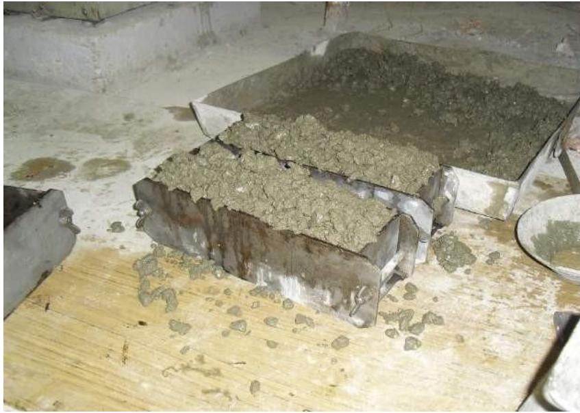
Figure II.11 : moulage du béton avant vibration.
