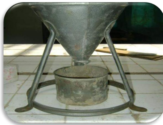
Figure II .1 : Essai de la masse volumique apparente.
