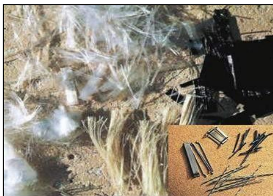
Figure I.6.Exemples des fibres d'acier, de carbone et de polypropylène.
