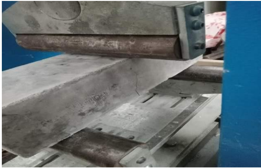
Figure II.14 : Essai de traction par flexion.
