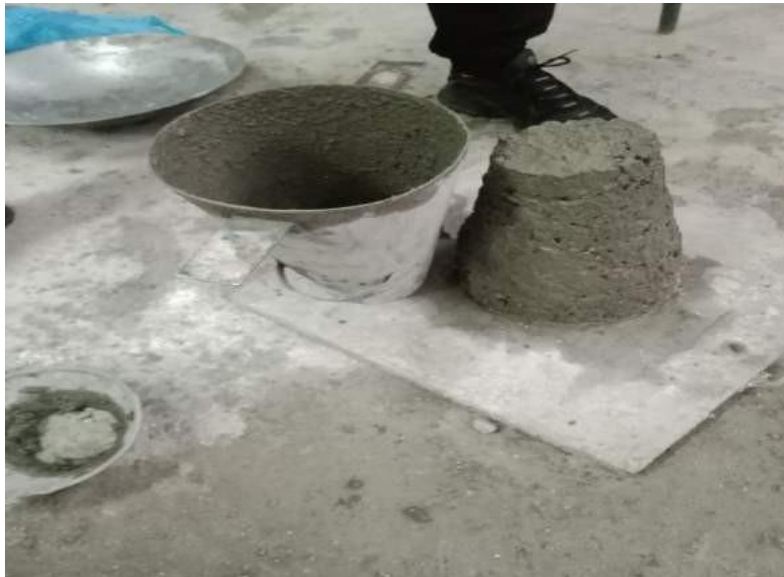
Figure II.10 : Essai d'affaissement au cône d'Abrams.
