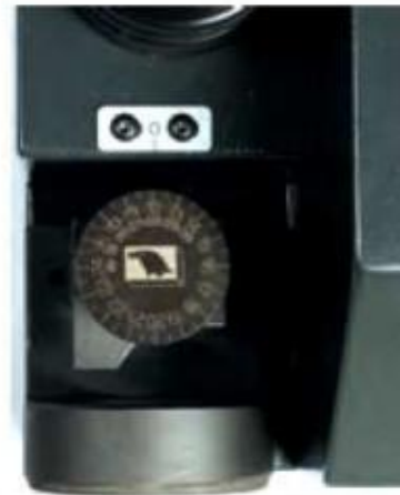
Réglage du diamètre de foret à affûter
