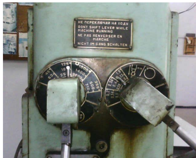
Figure 23 : Sélecteur des nombres de tours et des avances
