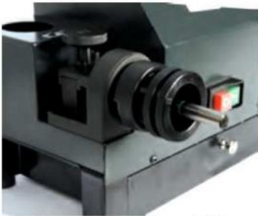
Positionnement du foret avant affûtage
