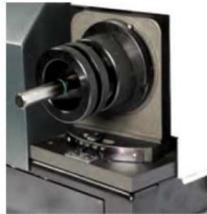
Réglage d'angle et affûtage de la pointe du foret
