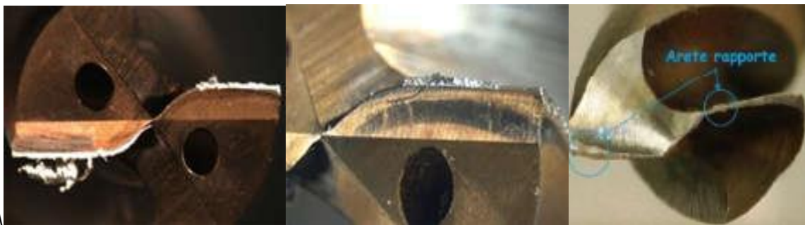
Figure 38 : Arête rapportée sur la surface en dépouille
