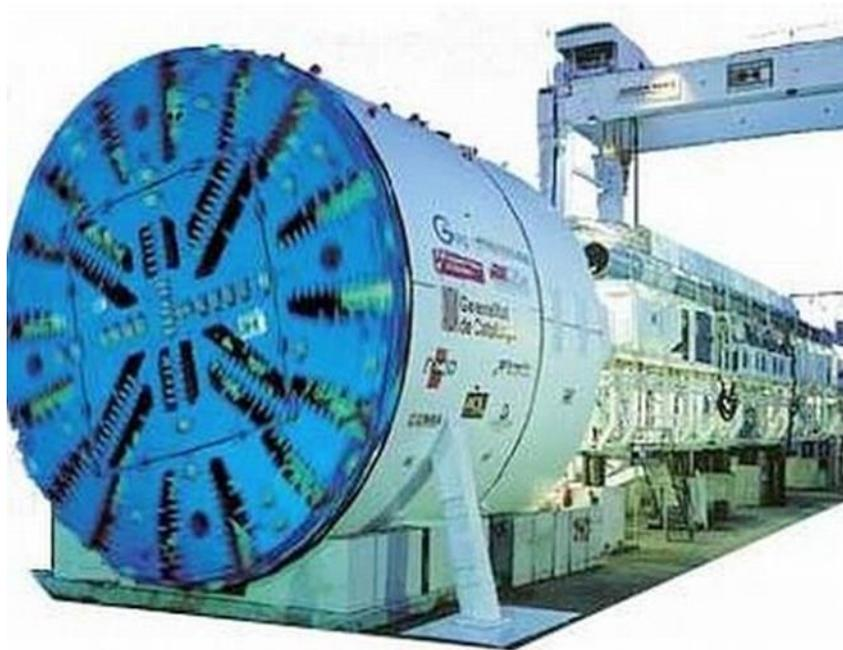
Figure I.12 : Tunnelier à bouclier.
