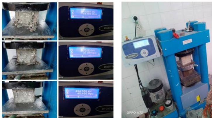
Figure 15. Résistances mécaniques à la compression.
