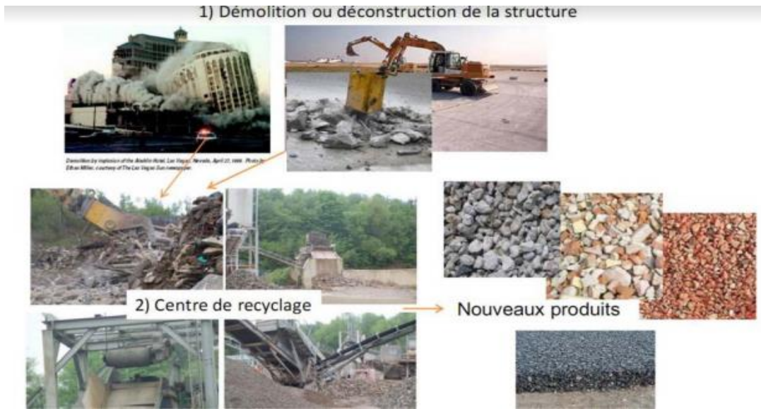
Figure 8. Les étapes de la production des granulats recyclés. [35].
