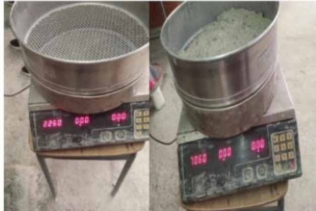
Figure 5. Dispositif de l'essai de stabilité au tamis.
