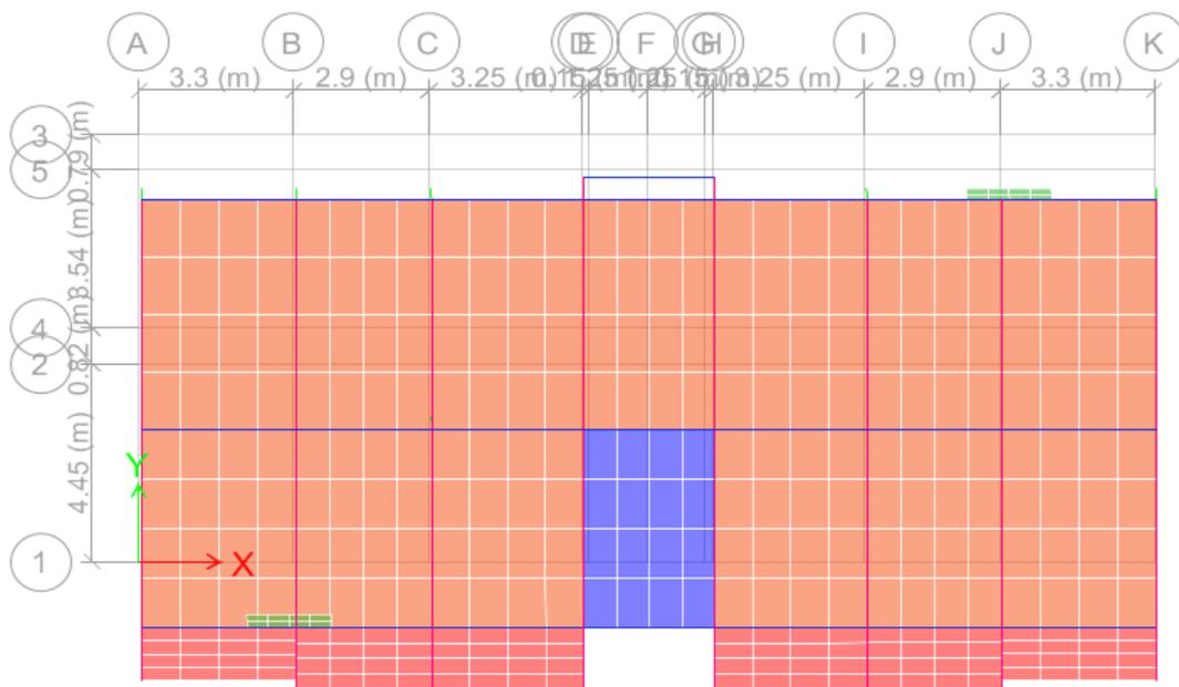
Figure 3.5 : Premier mode de déformation (translation suivant X)
