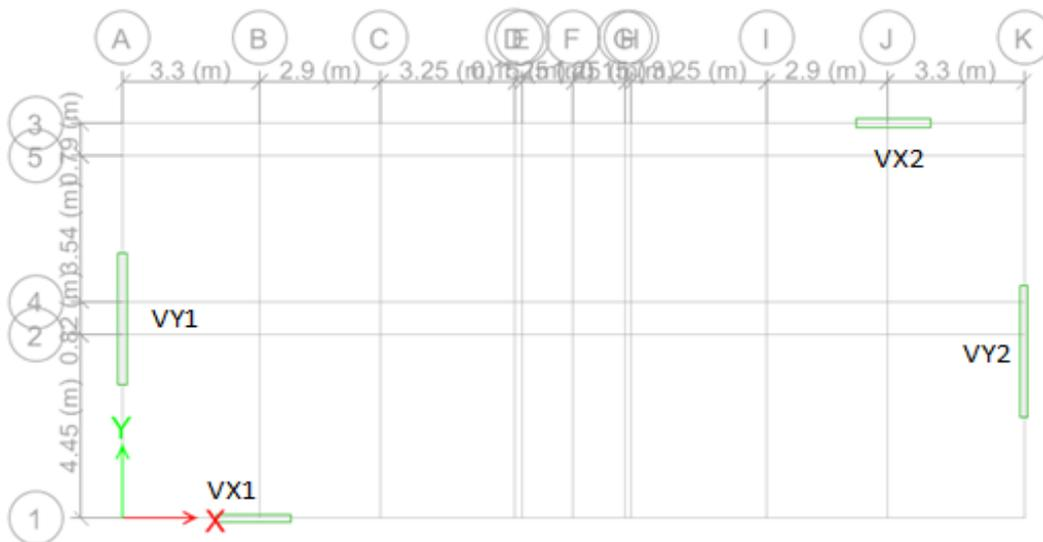
Figure 3.3: Disposition des voiles (2D)
