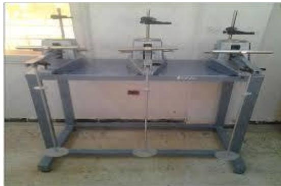
**Figure 3.14.** Appareillage de l'essai de compressibilité par palier l'œdomètre.
