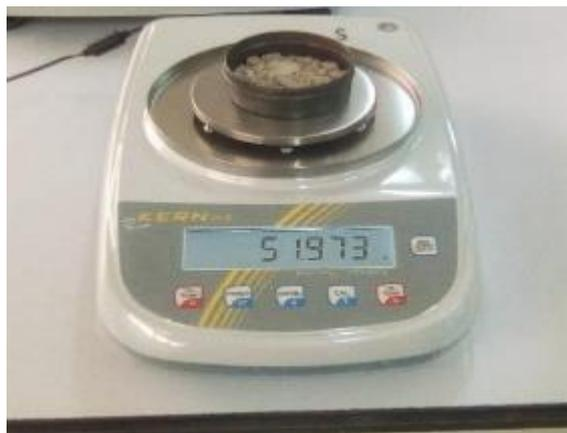
**Figure3.2.** Détermination la Teneur en Eau.
