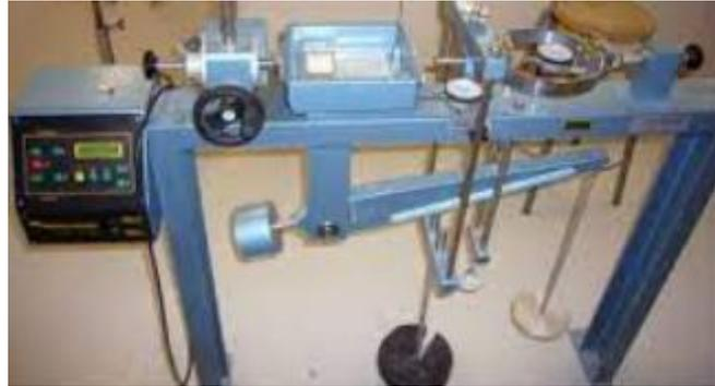
**Figure 3.17.** Machine de cisaillement.
