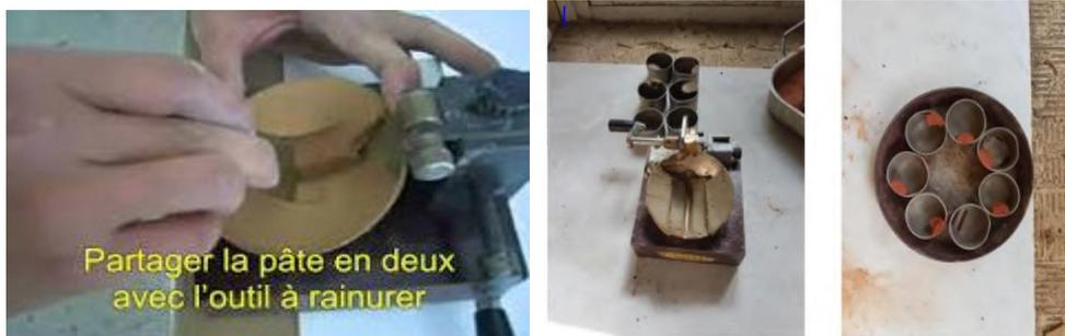
Figure3.7. Détermination la Limite de Liquidité.
