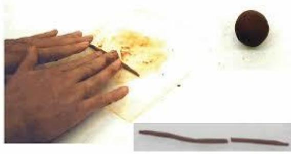
**Figure 3.8.** Détermination la Limite de Plasticité.
