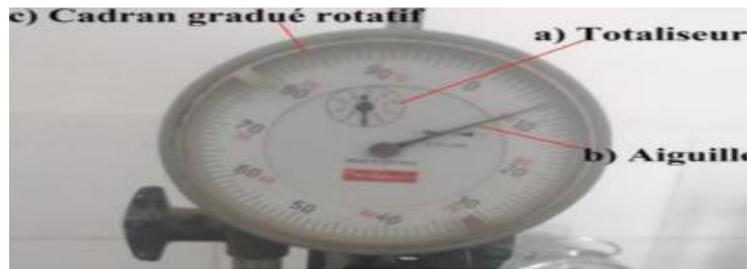
**Figure 3.13.** Comparateur de mesure(LNHC).
