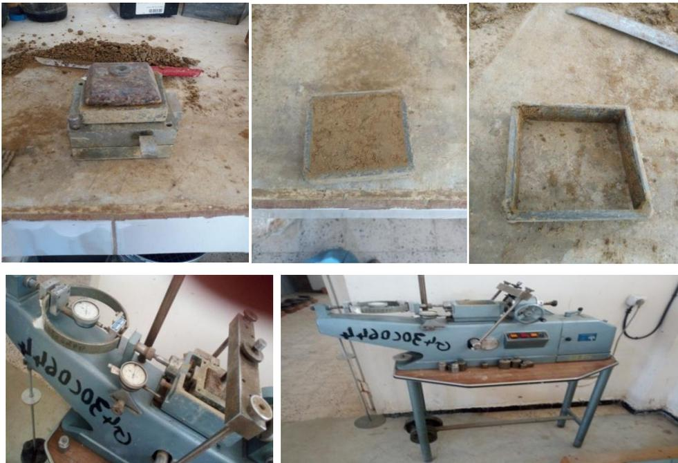
Figure 4.11. Essai de cisaillement
