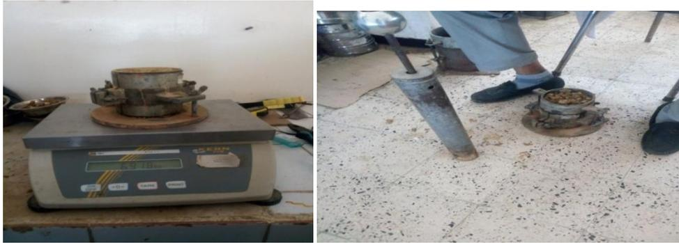
**Figure 4.4.** L'essai Proctor.
