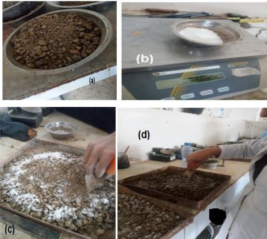
**Figure4.3.** Méthode de mélange. (a) Sol étuvé et concassé, (b) Pesage de la quantité de chaux, (c) Versement de la chaux sur le sol, (d) Mixage du sol avec la chaux.
