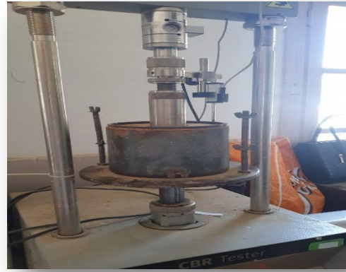
Photo 18.2 : Essais CBR Sol Sans Additive +16% Eau.
