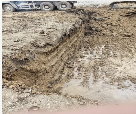
Photo 1.2 : Prélèvement de sol Bouzarora El Bouni (profondeur 1,60 / 2,00 m).
