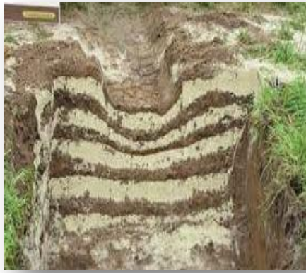
Figure 11.1 : Tassement d'un sol argileux.
