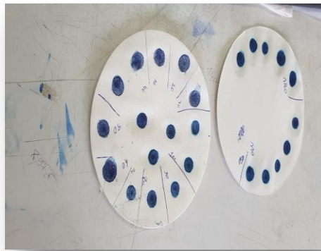
Photo 3.2 : Essai au bleu de méthylène.
