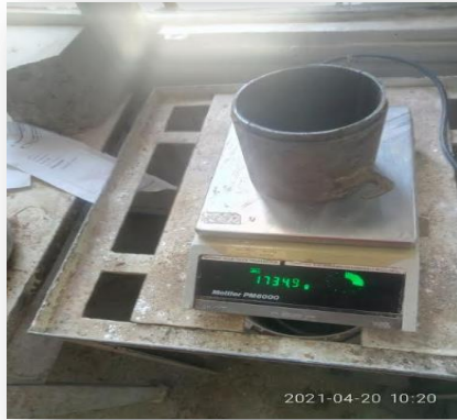
Photo 10.2 : moule de Proctor à laboratoire (LTPE-Annaba).
