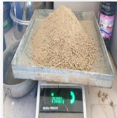
Photo 11.2 : l'essai Proctor pour sol sans additives dans laboratoire(LTPE. Annaba).
