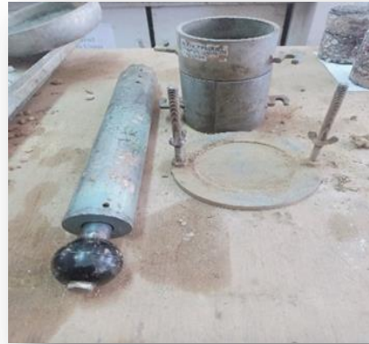
Photo 10.2 : moule de Proctor à laboratoire (LTPE-Annaba).
