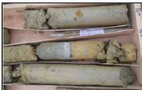
Carotte de la couche de sable argileux mêlé de graviers au trou B3 (à 17.7m)
