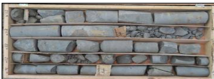
Carotte de grès principalement composée des blocs durs de roches au trou B4 (à 20m)
