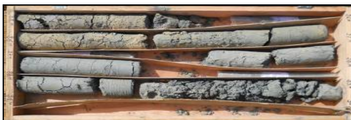
Carotte d'argilite au trou B7 (à 25m)
