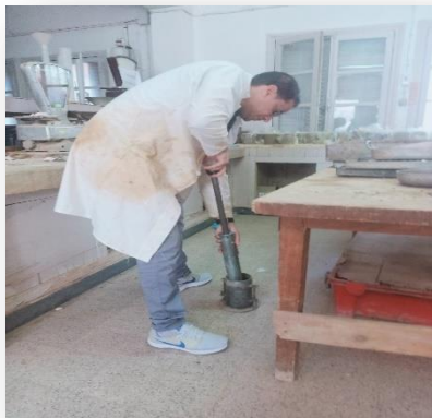
Photo 11.2 : l'essai Proctor pour sol sans additives dans laboratoire(LTPE. Annaba).
