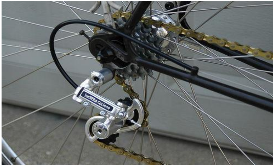
Figure .1.4. Système de chaîne et roues dentées [1]
