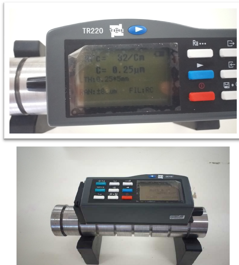
Figure III.6. Dispositif pour mesurer la rugosité
