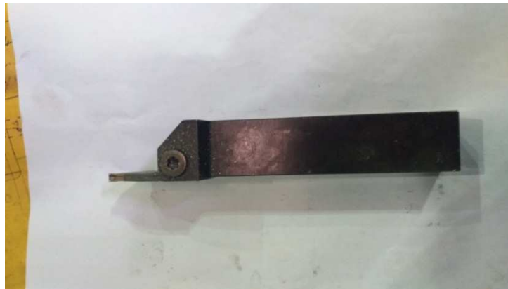
Figure III.3 : Outil à tronçonner
