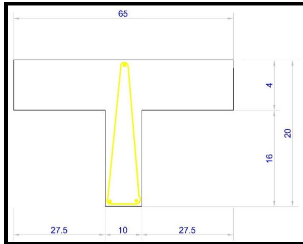
Figure45 : schéma de ferrailage plancher corps creux
