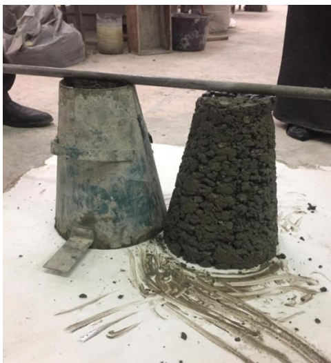
Figure II-8 Mesure de la consistance Affaissement au cône d'Abrams
