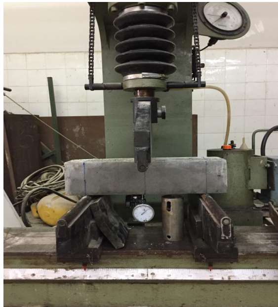
Figure III.6 Essai de traction par flexion de l'éprouvette en béton témoin
