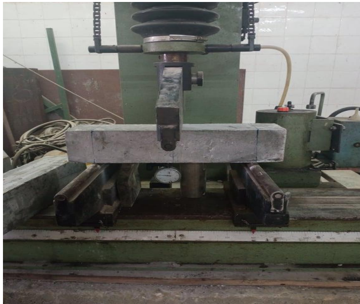
Figure III.17 La première phase de l'éprouvette en béton avec mélanges des deux fibres
