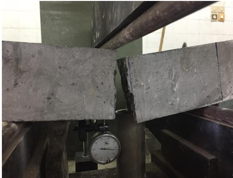
Figure III-7. Mode de fissuration et de rupture de l'éprouvette en béton témoin
