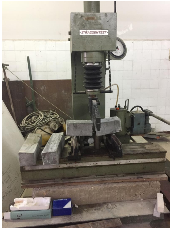
Figure III-4 La machine de traction par flexion trois points
