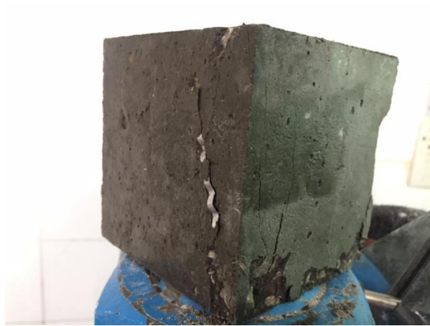
C/Béton avec fibres ondulées
