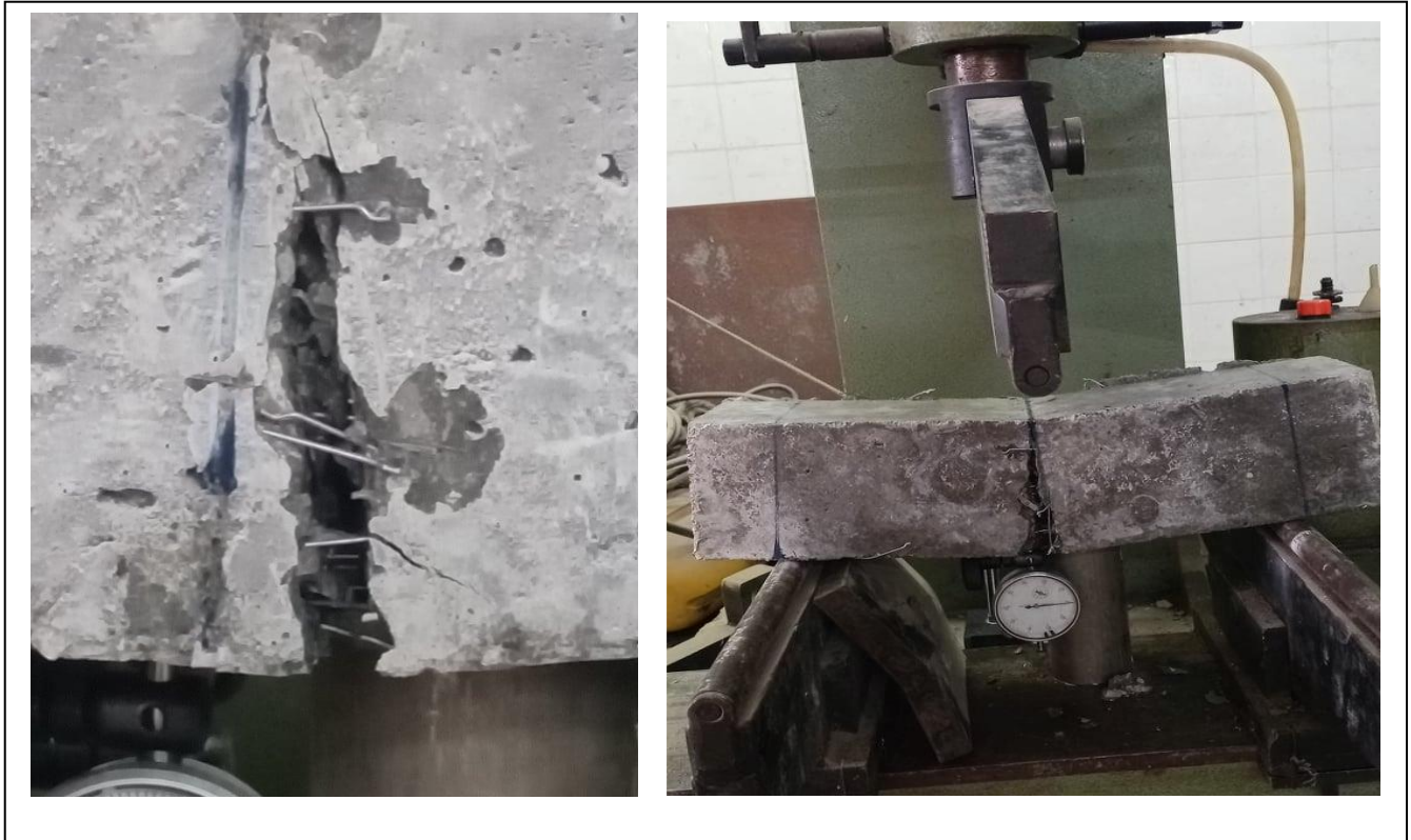
B/Agrondissement de la fissure sur l'éprouvette de béton avec fibres crochets
