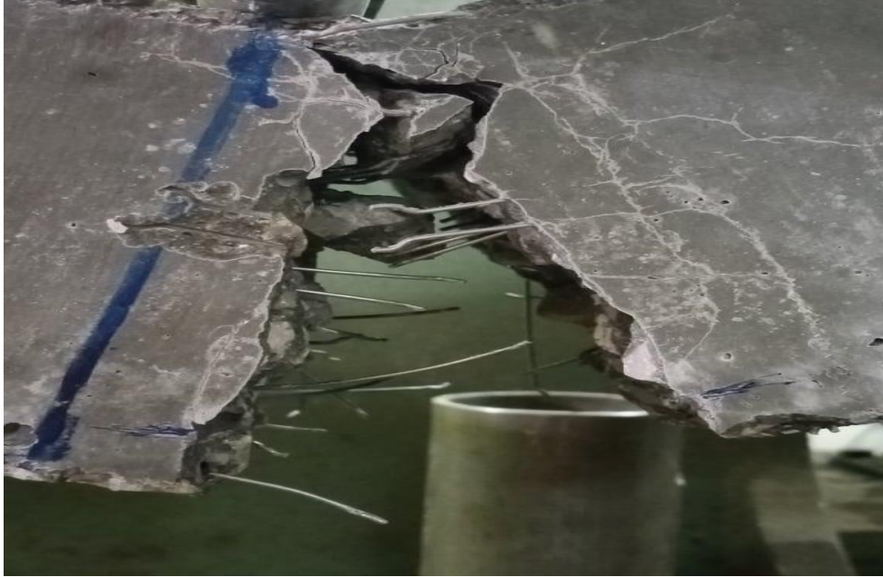
C/ Phase finale de rupture de l'éprouvette en béton avec déchaussement fibres crochets
