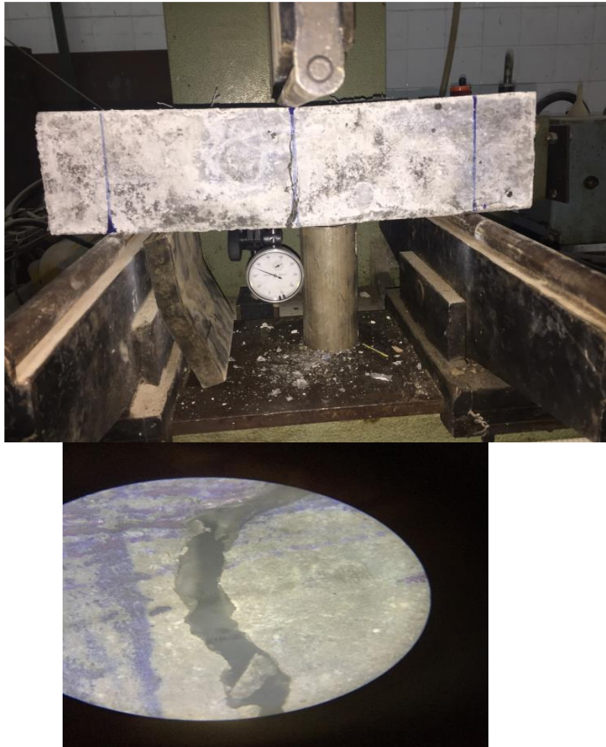
A/ Apparition de la première fissure sur l'éprouvette en béton avec fibres a crochets
