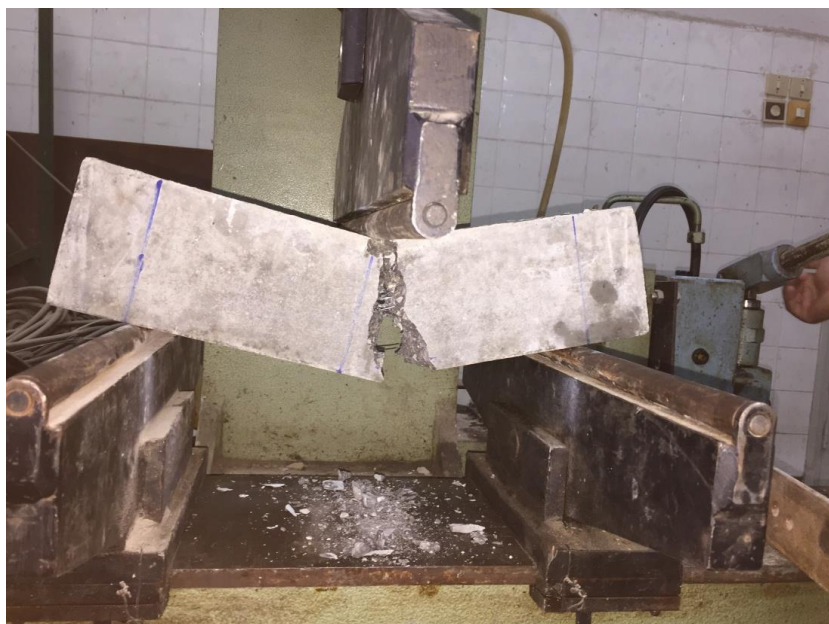
Figure III.17 La première phase de l'éprouvette en béton avec mélanges des deux fibres
