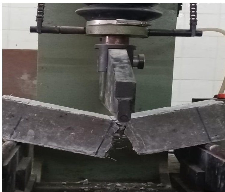
B/Agrondissement de la fissure sur l'éprouvette de béton avec fibres crochets
