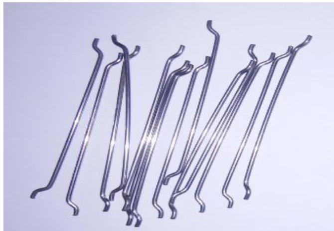
Figure II.6 : Fibres métalliques de forme crochet.
