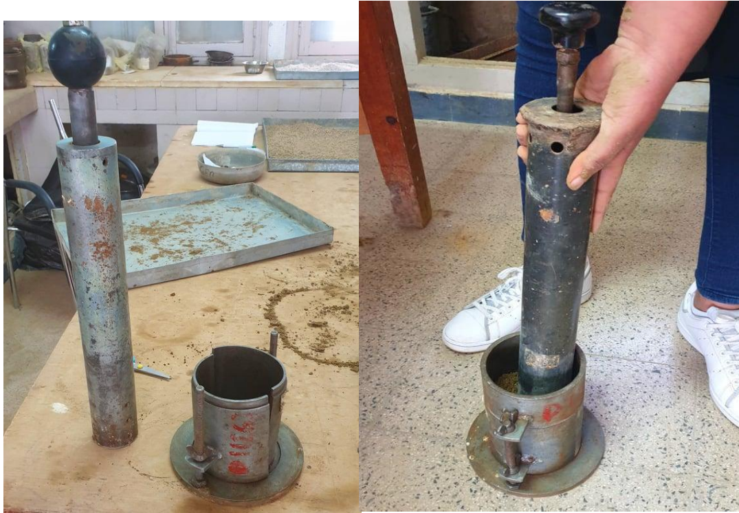
Figure II.12 : Appareillage nécessaire pour l'essai Proctor.
