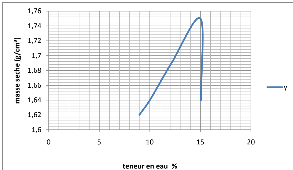
Figure II.31 : Courbe Proctor après l'ajout de la chaux
