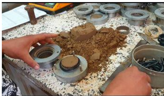
Figure II.16 : Les composants de cellule oedométrique
