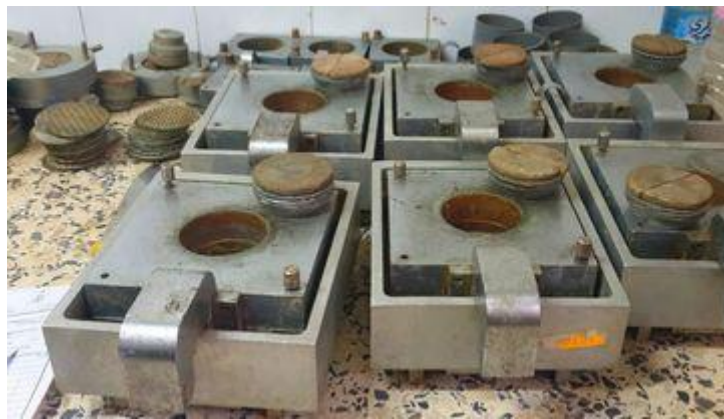
Figure II.20 : Boîte de Cisaillement.
