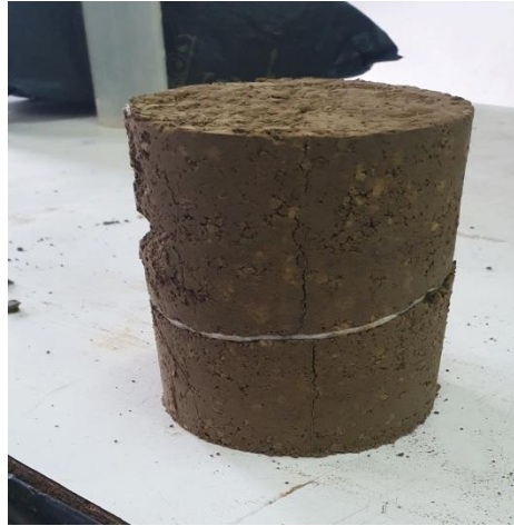
Figure III.4: Proctor avec une nappe de géotextile
