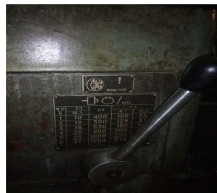
Figure 3 : Plaque signalétique de la boîte de vitesse de la machine
