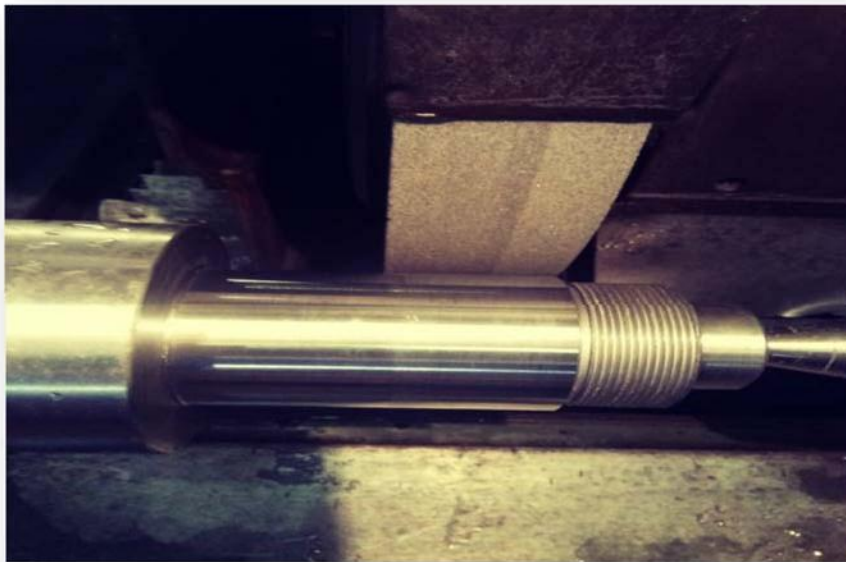
Figure 12 : Phase de rectification
