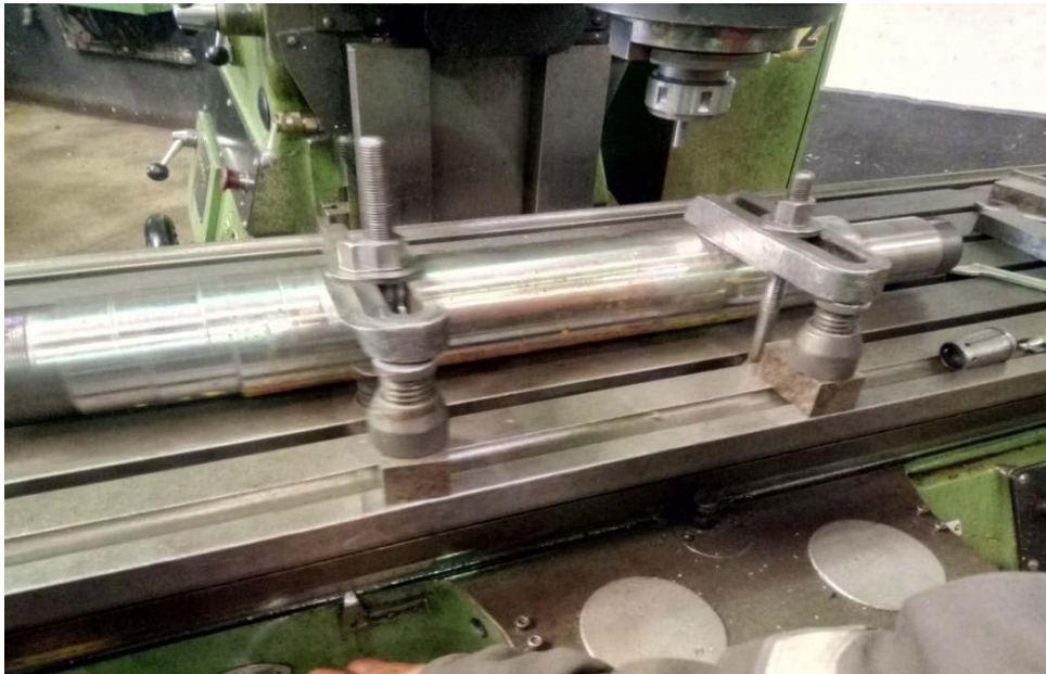
Figure 16: Positionnement et fixation de la pièce lors du dressage (suppression) des tétons
