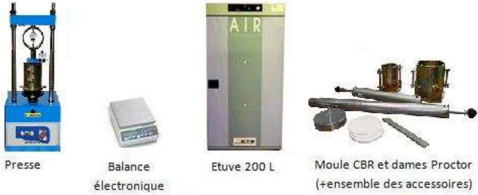
Figure 54 : matérielle de labo géotechnique
