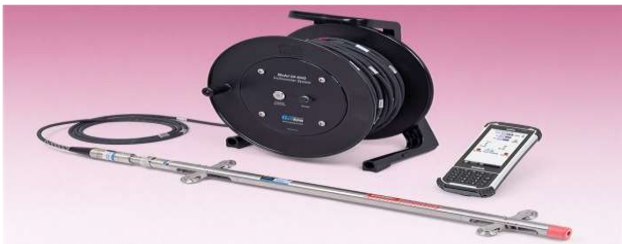
Figure 46 :L'appareillage de l'inclinomètre
