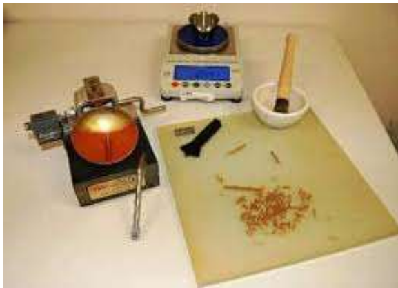
Figure 61: l'appareillage d'essai limite d'atterberg
