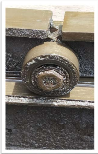
Figure III.5. Fusion de roulement due à la chaleur de la bobine
