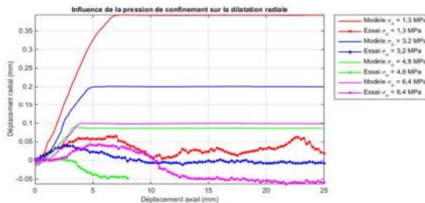
Figure 3.14 : Déplacement radial à l'extérieur de l'échantillon sous différentes contraintes de confinement
