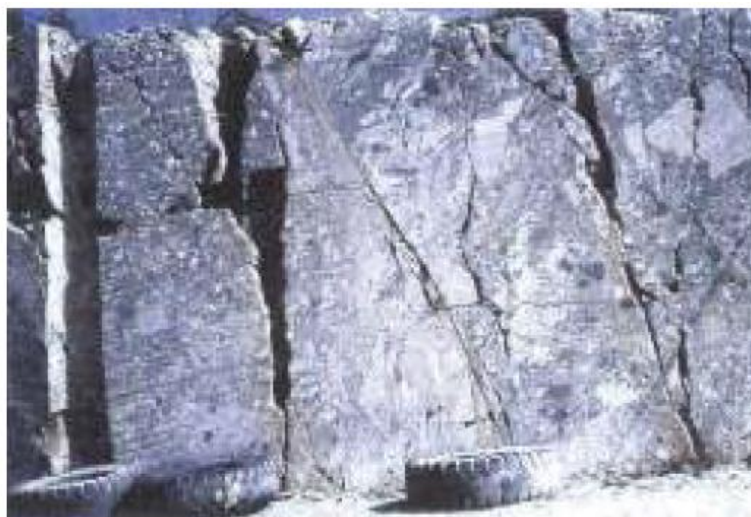
Figure 1.1 : Front de taille découpé au fil : le massif rocheux, milieu hétérogène, discontinu et anisotrope
