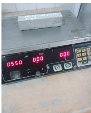
Figure III- 11 Pesage des éprouvettes de mortier à l'état durci
