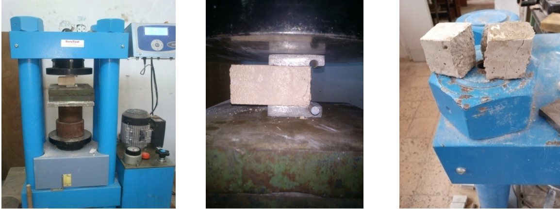
Figure III- 15 Dispositif de l'essai de compression
