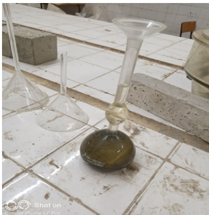
Figure II-5 : Détermination de la masse volumique des sables
