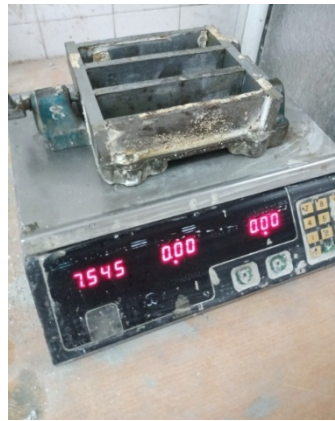
Figure III-9 Pesage du moule prismatique vide
