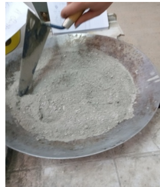
Malaxage à sec du sable naturel et recyclé
