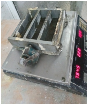
Figure III-9 Pesage du moule prismatique vide
