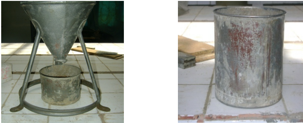
Figure II-8 : L'appareillage de la masse volumique apparente
