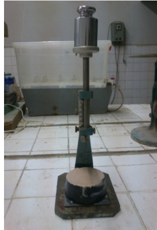
Figure II-3 : Mesure du temps de prise (Appareil de Vicat)
