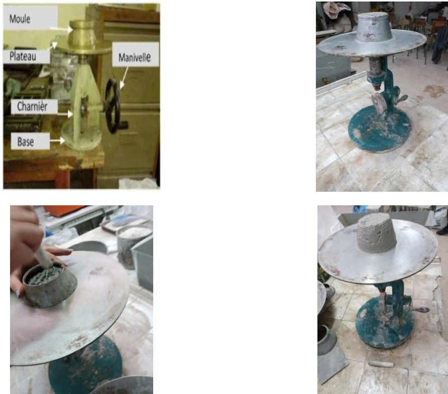
Figure III-7 Mesure de l'ouvrabilité
