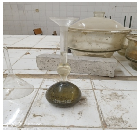
Figure II-5 : Détermination de la masse volumique des sables
