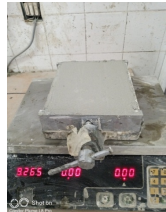
Figure III-10 Mesure Masse du moule remplis de mortier
