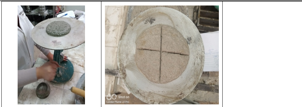
Figure III-8 Etapes de mesure de l'ouvrabilité
