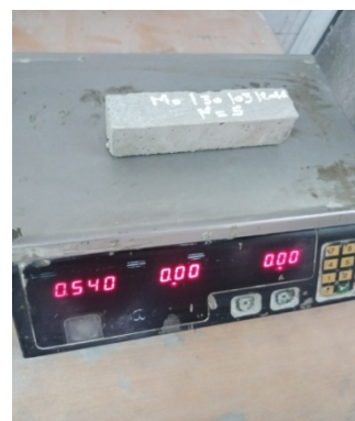
Figure III- 11 Pesage des éprouvettes de mortier à l'état durci
