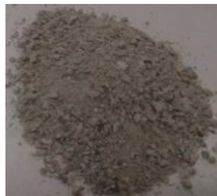
SR mouillé et mélangé pendant 10 min
