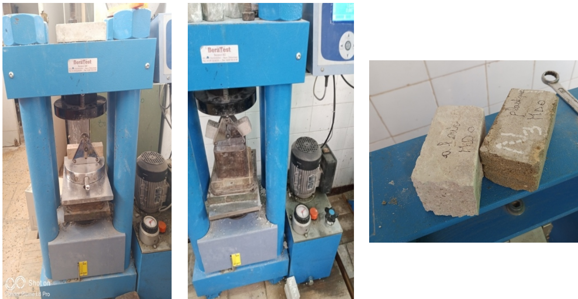
Figure III- 14 Dispositif de flexion à 03 points
