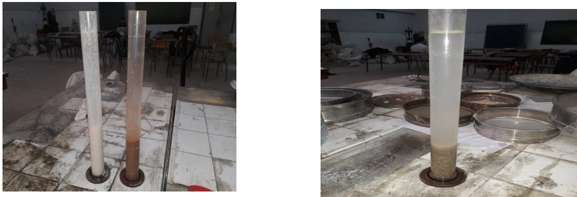
Figure II-18 Photos de l'essai d'équivalent de sable
