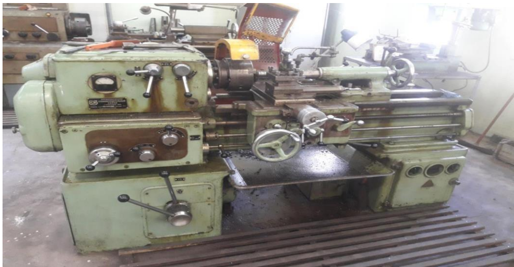
Figure III. 1 : Tour universel modèle AI616 fabriqué en URSS
