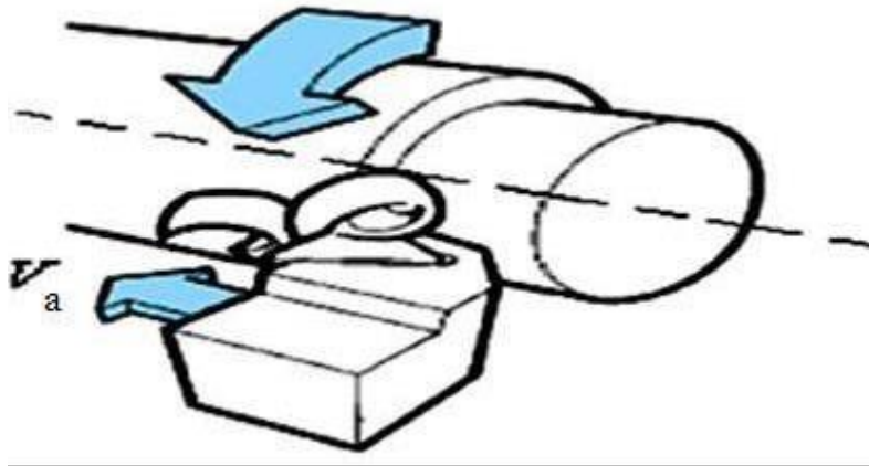
Figure I.19 :Vitesse d'avance V_a . [4]
