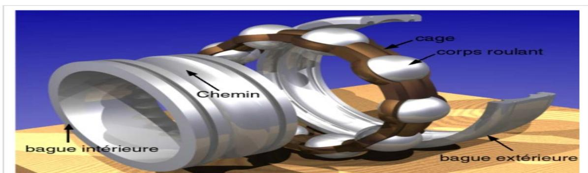
Figure- I-1- Différentes composantes d'un roulement [3].
