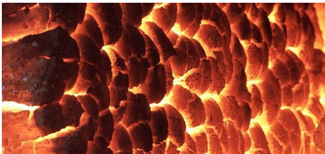
Fig 12 : Coke après sa sortie du four ou défournement.
