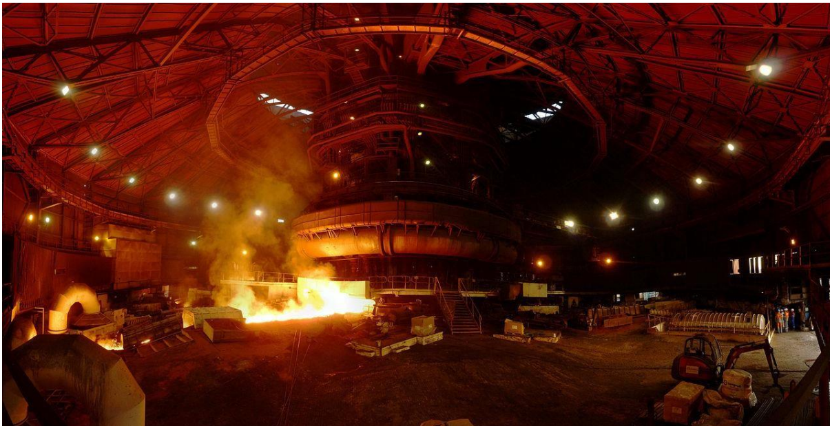
Fig 03 : Photo panoramique d'une coulée au Haut fourneau 2 de Dąbrowa Górnicza (Pologne).
