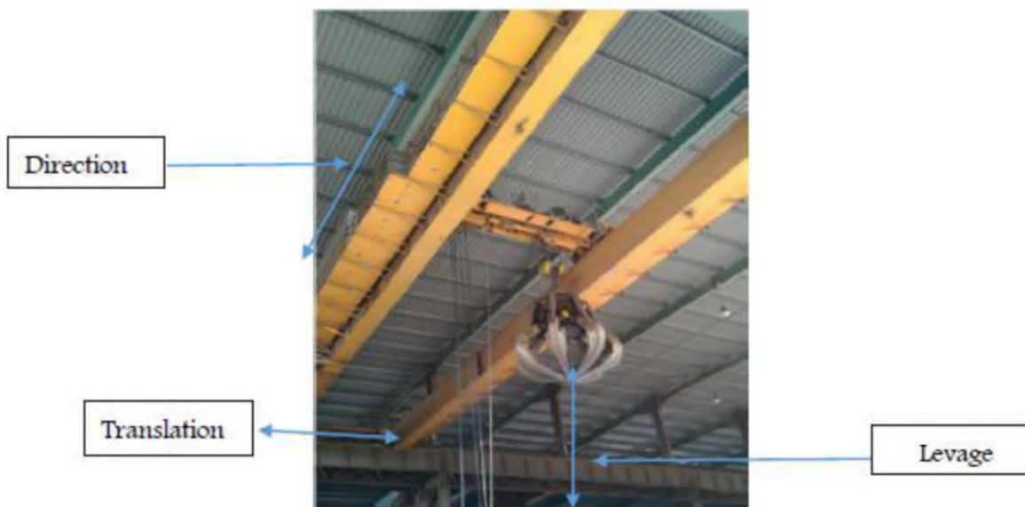
Figure 16 : Mouvement possible du pont roulant.
