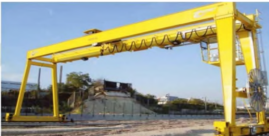
Figure 02 : Portique de manutention
