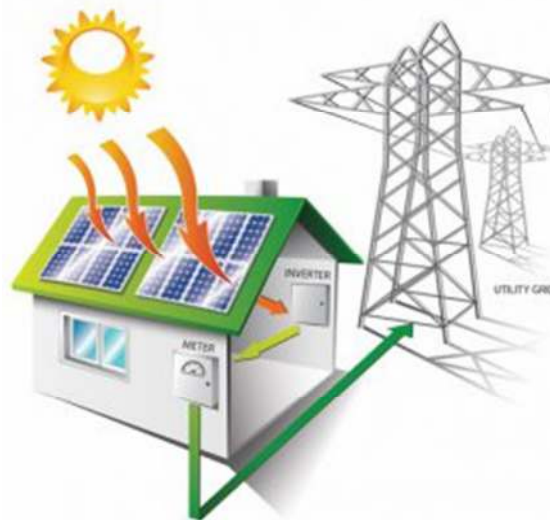
Figure. I.6 : Structure d'un système PV raccordée au réseau
