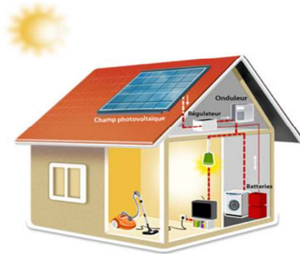
Figure. I.4 : Structure d'un système PV autonome
