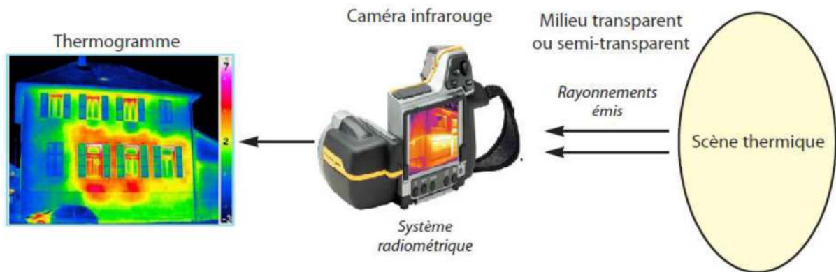
Figure.III.3 Principe de fonctionnement de la caméra infrarouge.
