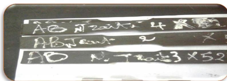
Figure II.6 Éprouvette Avant essai (acier API-X52 Selon la Norme API 5L).
