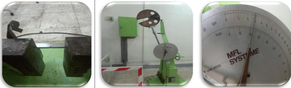
Figure II.15 Déroulement de l'essai de résilience
