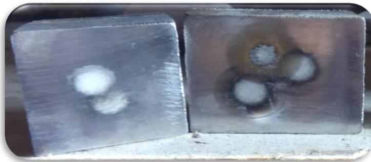
**Figure II.3** Echantillons après bombardement
