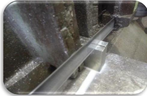
Figure II.11 Coupe des éprouvettes sur scie mécanique
