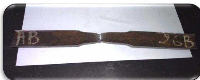
Figure III.2 Éprouvette de traction de l'acier API-X52 après essai.
