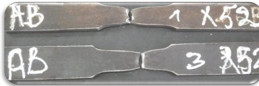
Figure II.9 Epreuve de traction de l'acier API-X52Q après essai.
