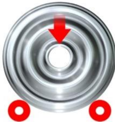
Figure III.2 : Emplacement de la roue sur les galets.
