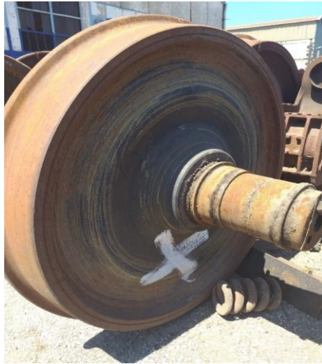
Figure II.7 : Un essieu ferroviaire orienté vers le reprofilage.
