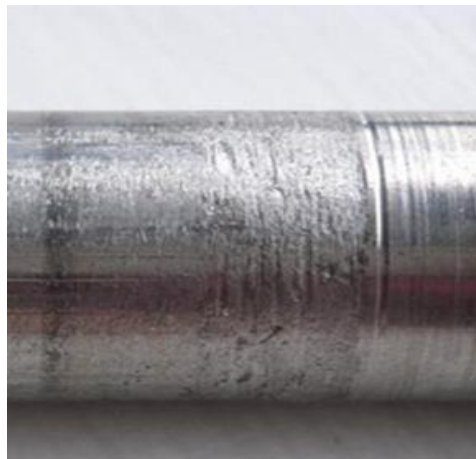
Figure I.3 : Usure par adhésion
