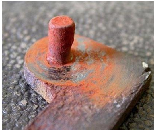
Figure I.8 : Apparences d'une usure par corrosion.
