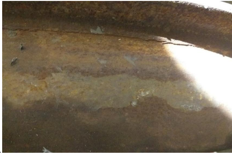
Figure II.6.a : Usure de la table de la roue ferroviaire.
