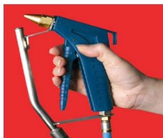
Figure4-9: Ionisation de l'air par un pistolet
